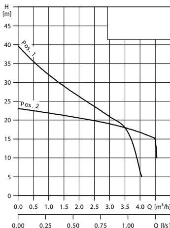
Рис. 2 Расходо-напорные характеристики и позиции эжекторного клапана
