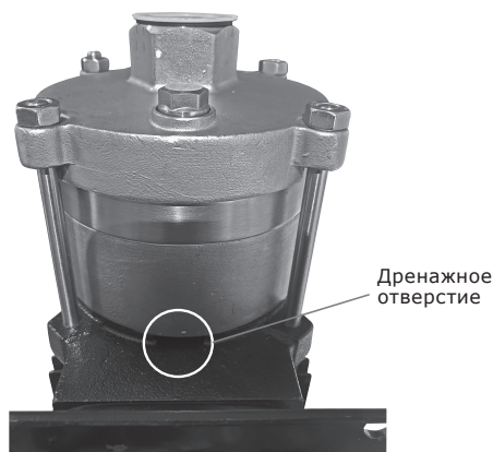
Рис. 10 Дренажное отверстие торцевого уплотнения
