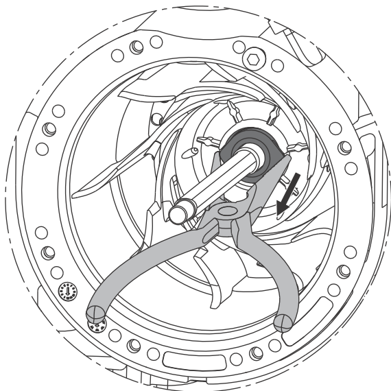
Рис. 12 Снятие неподвижного седла вала
