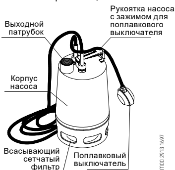
Рис. 1 Конструкция насосов Unilift AP
