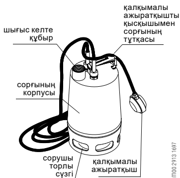
1-сур. Unilift AP сорғыларының конструкциясы
