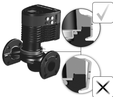
Рис. 18 Закрепление головной части насоса на корпусе насоса
