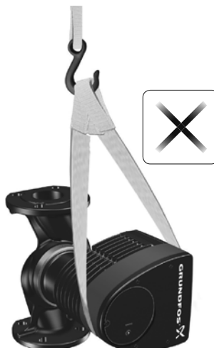
Рис. 10 Неправильный способ стропки насоса
