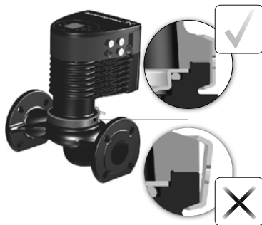
18-сүр. Соркысманын корпусуна соркысманын баш бөлүгүн бекитүү
