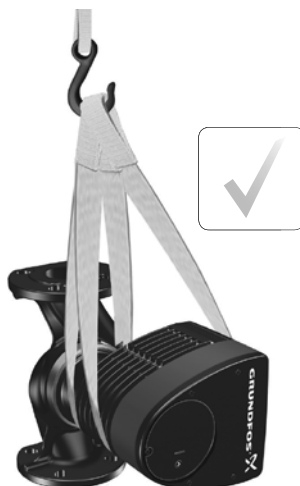
Рис. 9 Правильный способ стропки насоса
