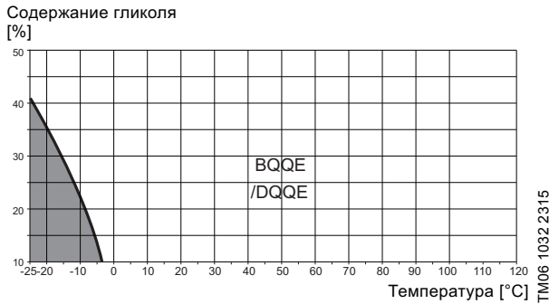
Рис. 35 Рабочий диапазон уплотнений вала из EPDM
