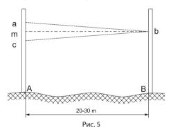
На ровной поверхности выберите две фиксированные цели на удалении 20–30 м друг от друга (например, деревья, столбы, стены). Сначала сделайте отметку на высоте а в точке измерения А (высота а должна
