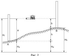
Наблюдатель поворачивается в противоположном направлении и наводит прибор на уровень точки В. Затем, описанным выше образом, проводится измерение высоты b.
