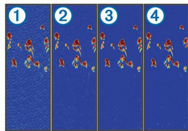
При последовательной установке значения ①, соответствующего выключеному состоянию, минимальной ②, средней ③ и максимальной ④ чувствительности уровень шума постепенно снижается, но это практически не влияет на сильные эхо-сигналы, отраженные от целей. Для удаления помех с экрана следует использовать настройку, максимально снижающую помехи и улучшающую изображение. Чтобы полностью устранить помехи, необходимо исправить проблемы, связанные с установкой устройства.
