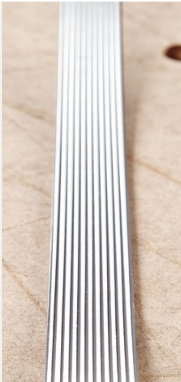
Нанесение клея на кромочный материал
