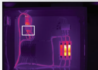
Полноэкранный снимок, полученный с расстояния 1,5 метра (5 футов) при помощи тепловизора TiX1000. Увеличенное изображение зоны, находящейся в белой рамке, приводится ниже.
