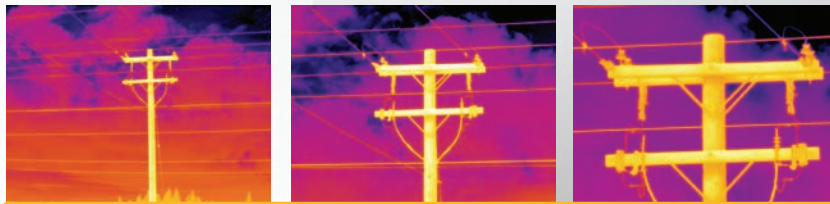
Стандартный объектив (слева), телеобъектив 2x (по центру) и телеобъектив 4x (справа) — посмотрите на правильное ИК-изображение критически важных деталей
