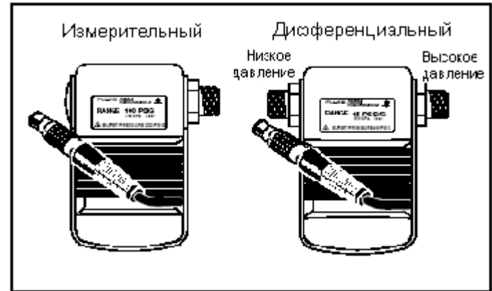
Рисунок 12. Измерительный и дифференциальный модули давления
