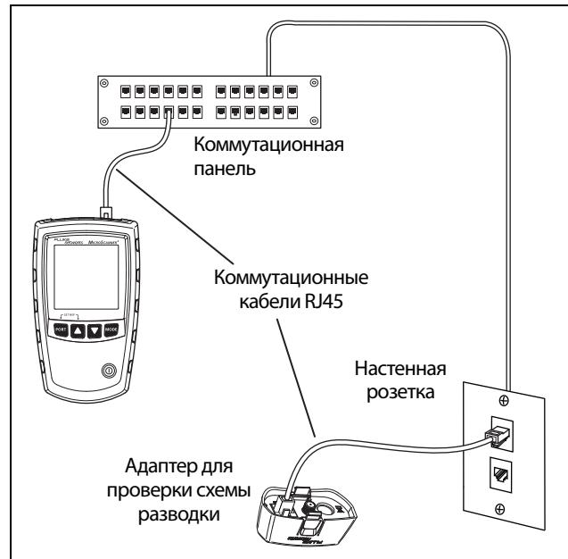
Рис. 7. Подключение к сети на основе витой пары
