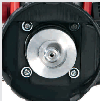
Амортизационный элемент между шпинделем и установленной насадкой сокращает вибрации, повышает плавность хода, улучшает направление и увеличивает срок службы машины.
