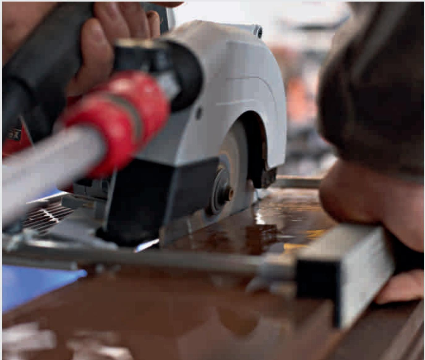
Жесткая и надежная пила CS 60 WET идеальна при обработке подоконников, столешниц, фасадной плитки, мозаичной плитки в садовом и ландшафтном строительстве, а также санации стыков при изготовлении полов.
