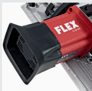
Мощный электродвигатель мощностью 1400 Вт с высоким врачающим моментом. Резиновая защита предотвращает прямое всасывание распыляемой воды, и тем самым предохраняет электродвигатель.
