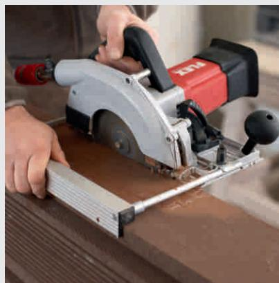
Вследствие применения точного и устанавливаемого на любой из сторон параллельного упора, посредством пилы CS 60 WET можно производить косую распиловку и под отрицательными углами.
