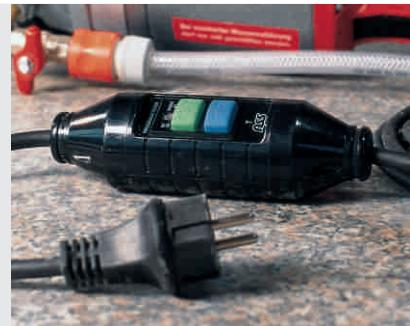
Защитный включатель FLEX PRCD обеспечивает электрическую безопасность при мокром шлифовании. Срабатывает мгновенно (< 15 миллисекунд), благодаря необходимой чувствительности срабатывания. С защитой от повторного включения при сбоях в электроснабжении.
