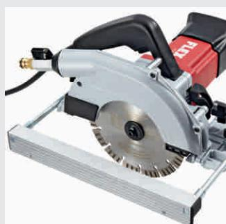
Смонтированный в верхней части параллельный ограничитель с направляющим кантом увеличивает площадь соприкосновения стола пилы. Направленный вниз направляющий кант облегчает параллельный рез в ребре заготовки.
