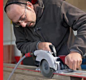
Новая пила CS 60 WET является дальнейшей конструктивной разработкой оправдавшей себя пилы CSW 4161. С новой пилой CS 60 WET можно не только производить чистую и точную резку, но и производить косую распиловку под углом в диапазоне 0-45°. Пила позволяет также настраивать глубину резки в пределах 0-60 мм (с направляющей шиной 0-54 мм), и тем самым оптимально пригодна для изготовления сливных полочек и влагоотводящих желобков в подоконниках или лестничных ступеньках.
