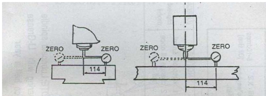
После крепления станка на основании четырьмя болтами, отрегулируйте станок по горизонтали: отклонение не должно превышать 0,04/1000 мм (во всех направлениях). При необходимости под основание установите балансировочные пластины.
