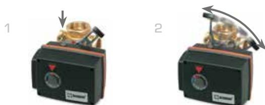
1 Для управления клапаном вручную, нажмите кнопку и переведите рычаг. Электрический ток будет автоматически отключен до тех пор, пока кнопка находится в нижней позиции.
