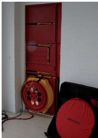
*Оборудование BlowerDoor обычно устанавливается в проеме входной двери.*
