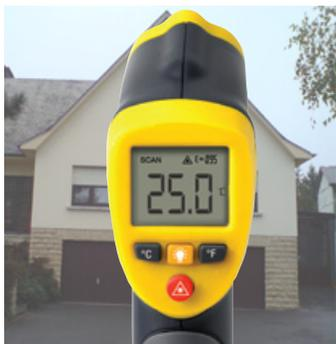
*ИК-термометр, измерение температуры в одной точке*
