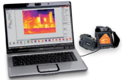
Большинство программных пакетов, поставляемых с тепловизионными камерами, позволяют выполнять базовый анализ и создавать отчеты. Они содержат функции измерения температуры в одной точке и другие базовые средства измерения.
