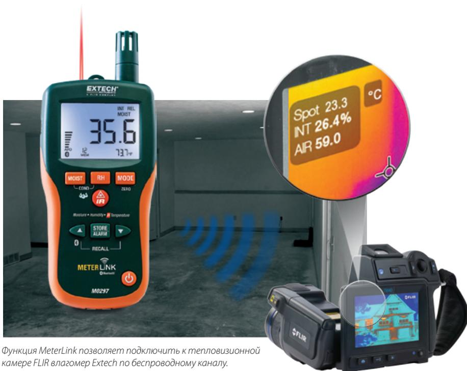
*Функция MeterLink позволяет подключить к тепловизионной камере FLIR влагомер Extech по беспроводному каналу.*
