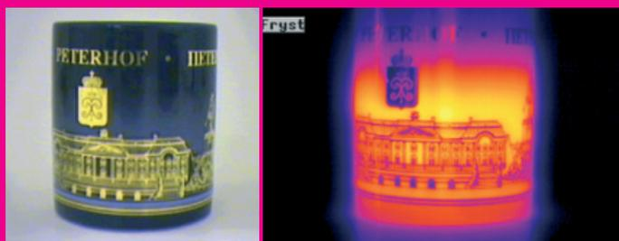
*При взгляде на ИК-изображение может показаться, что золотистая краска холоднее, чем поверхность чашки. В действительности они имеют одинаковую температуру: различия в интенсивности инфракрасного излучения обусловлены разной излучающей способностью.*
