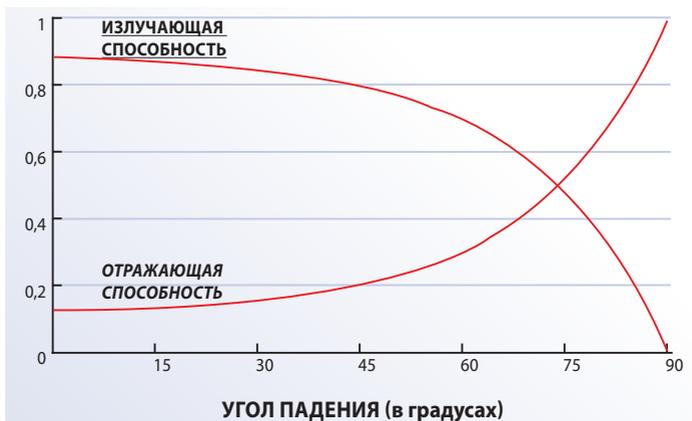
Угловая зависимость излучающей способности стекла
