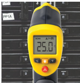
ИК-термометр: измерение температуры в одной точке
