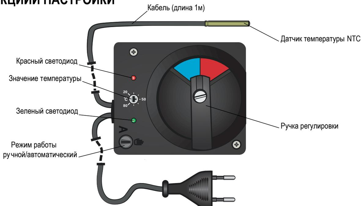
Значение заданной температуры можно регулировать с помощью небольшой отвертки (см. раздел 9.1 «Регулировка значения температуры»). Два светодиода показывают текущую выполняемую операцию или сигнализируют об ошибке (см. раздел 9.2 «Светодиоды» и раздел 11. «Ошибки и устранение неисправностей»). С помощью отвертки сервопривод может быть переключен из автоматического режима работы в ручной режим. В этом режиме он управляется с помощью ручки регулировки.
