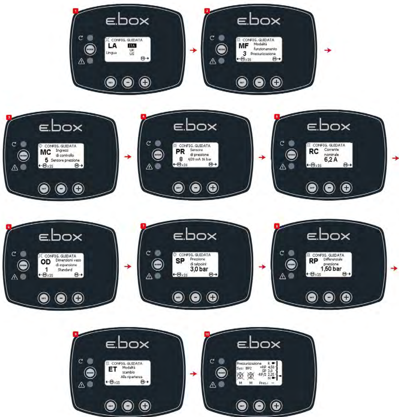
Εικόνα 12: Διαμόρφωση με Αισθητήρα πίεσης
