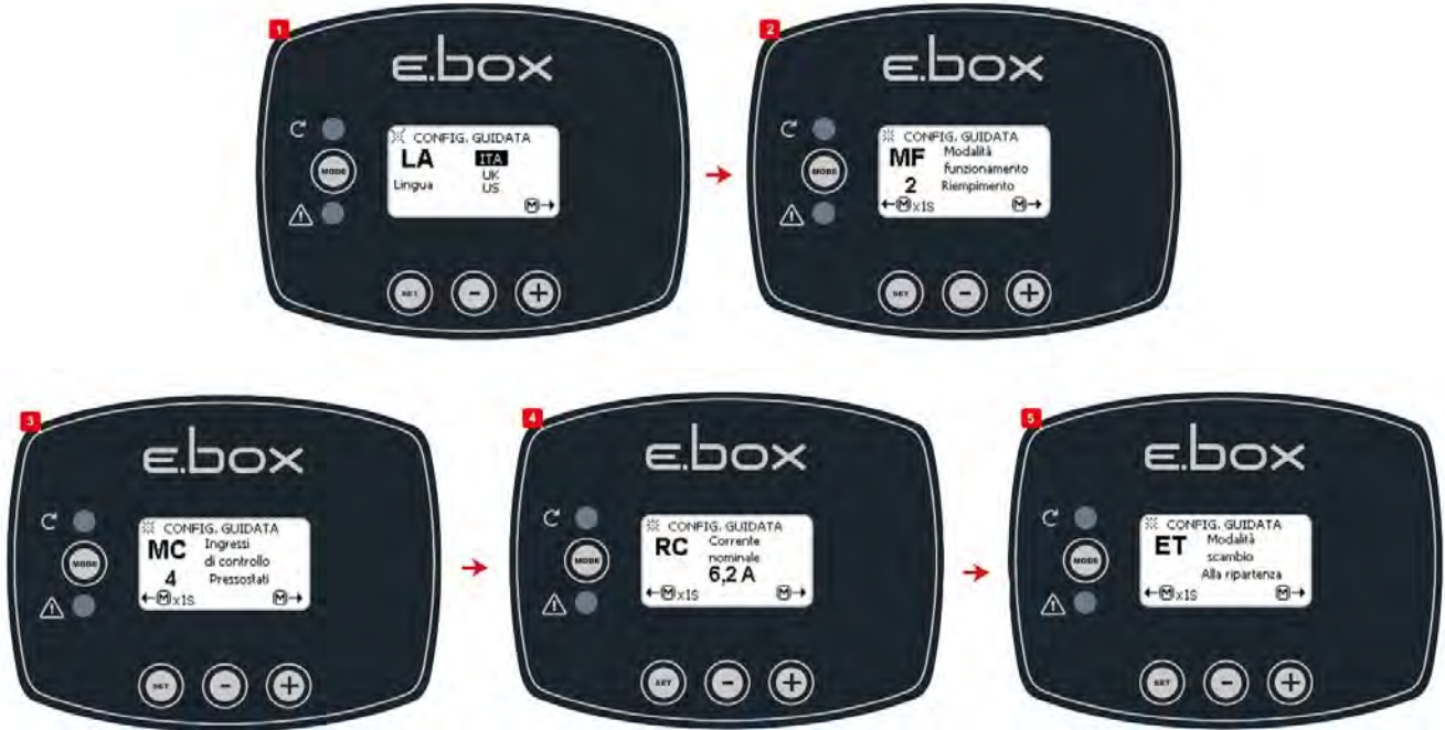
Abbildung 24: Füllkonfiguration mit Schwimmerschaltern oder Standsonden
