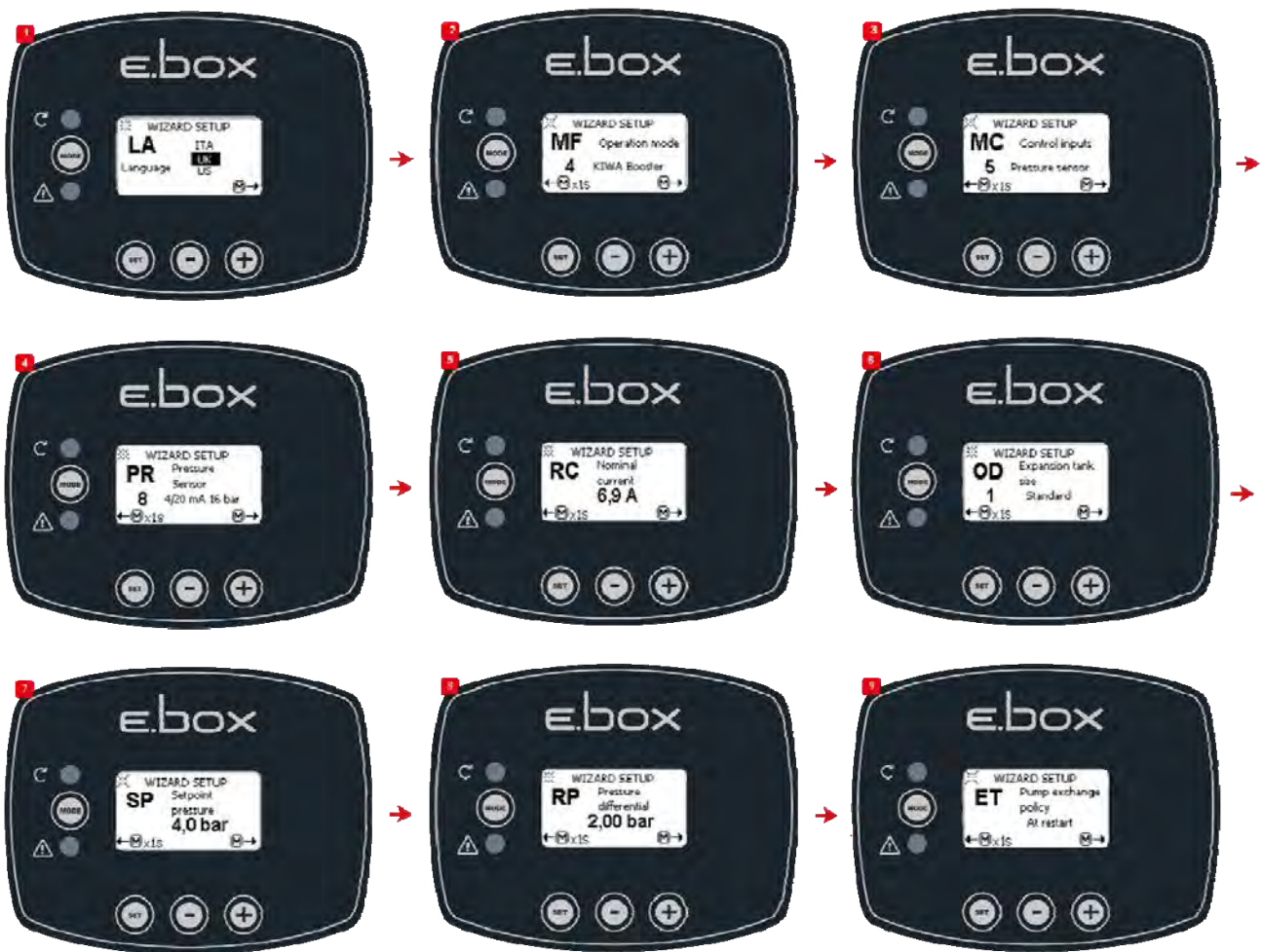
Figure 48 : Pressurisation KIWA avec capteur de pression
