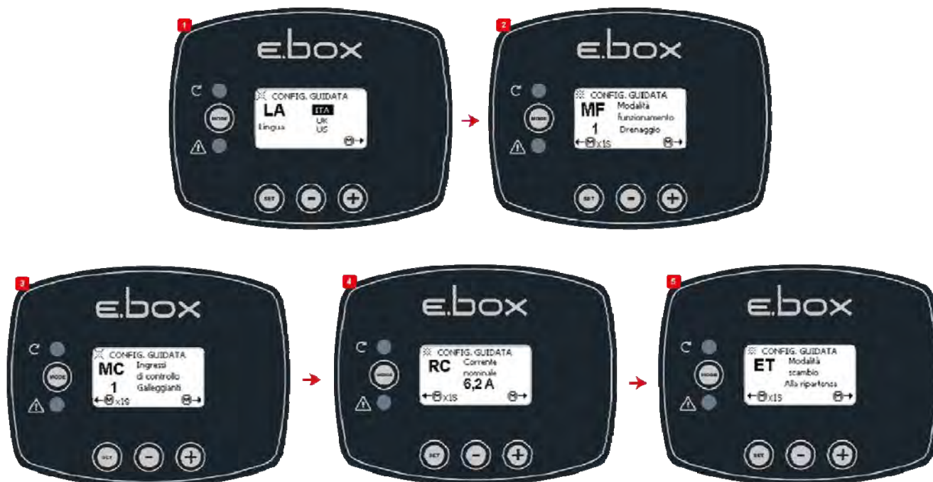
Схема 36: Конфигурация Дренажа поплавков или зондов уровня
