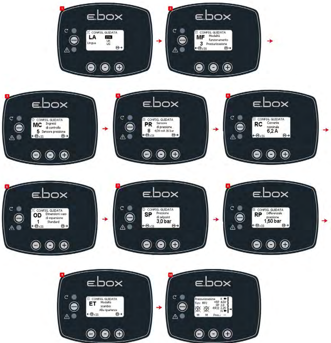
Figura 12: Configurazione con Sensore di pressione
