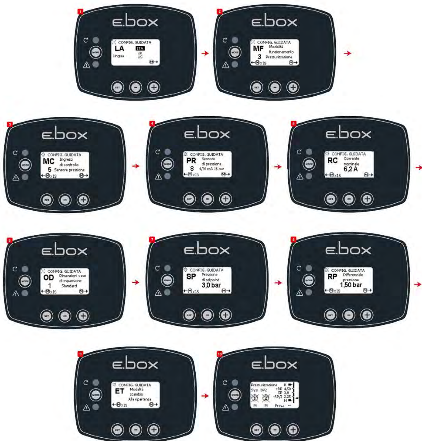
Rysunek 12: Ustawianie za pomocą czujnika ciśnienia
