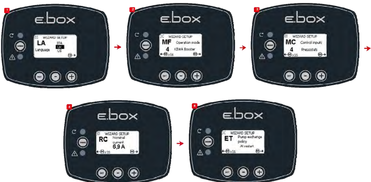
Afbeelding 49: Configuratie met Kiwa-drukschakelaars
