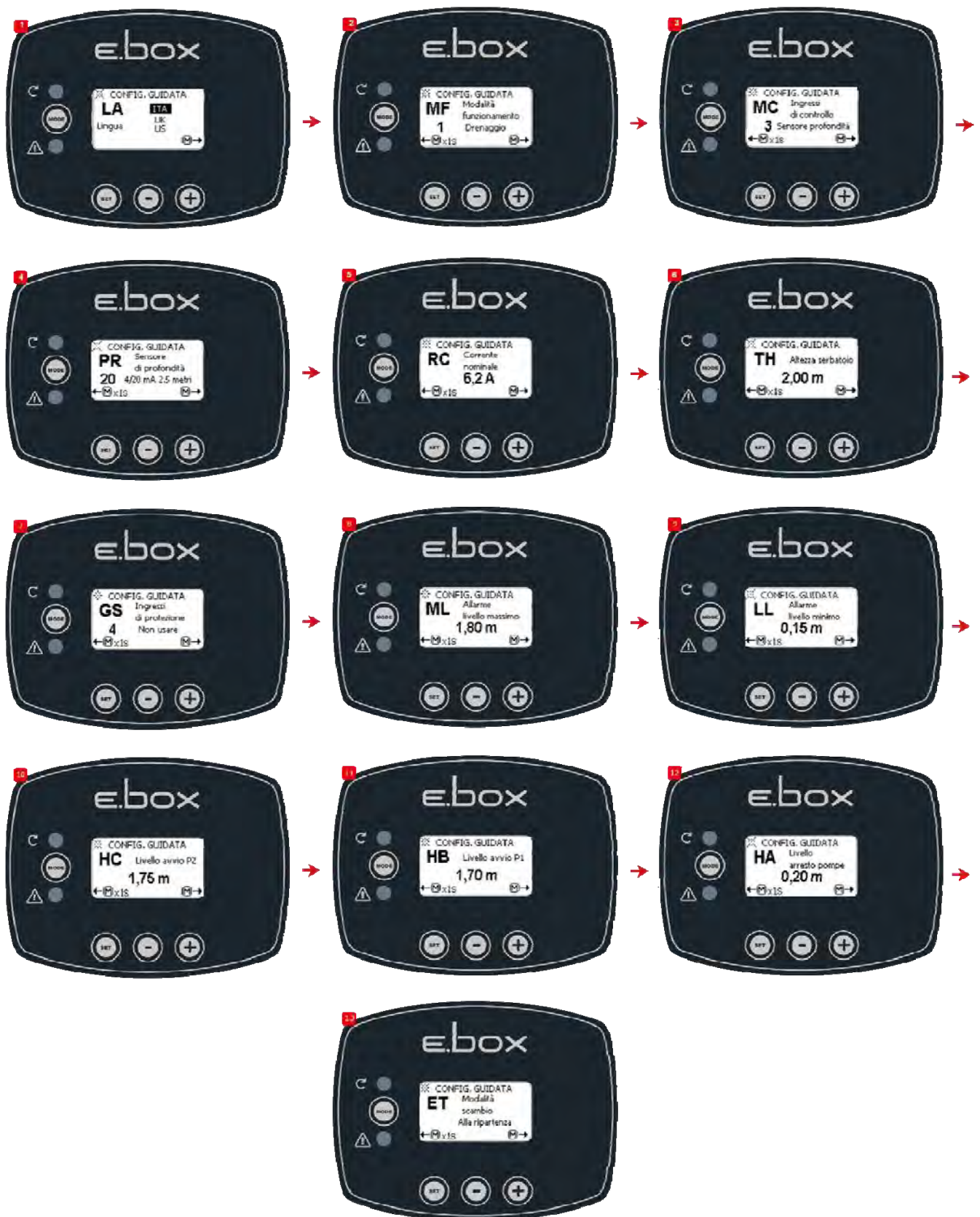
Obrázek 38: Nastavení pouze s hloubkovým čidlem
