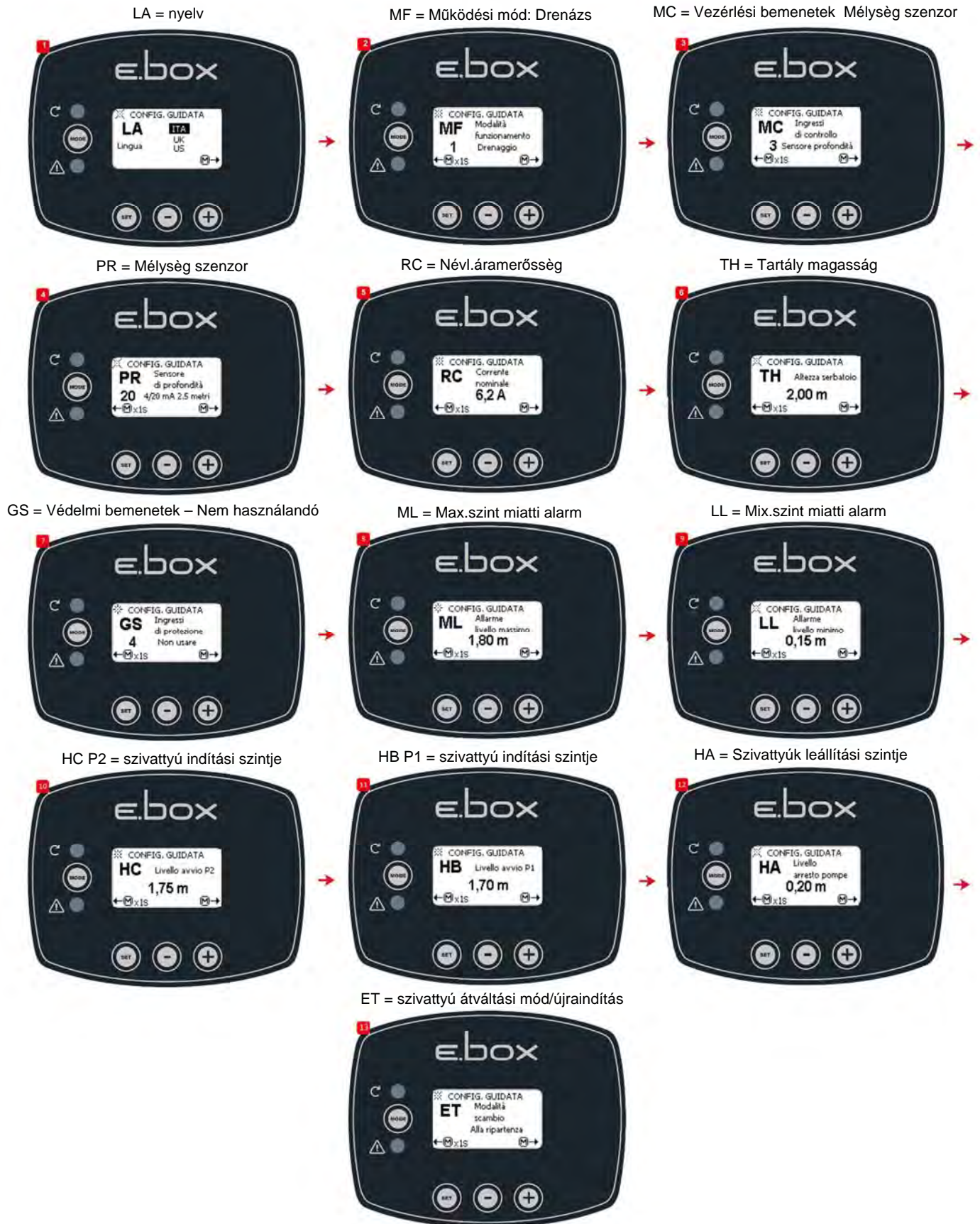
38.ábra: Konfiguráció egyetlen mélység szenzorral
