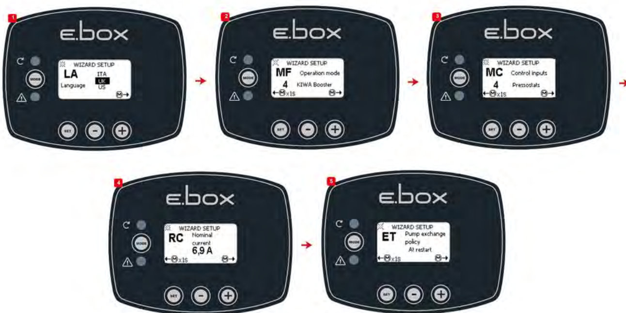
Figura 49: Configurazione Kiwa con Pressostati
