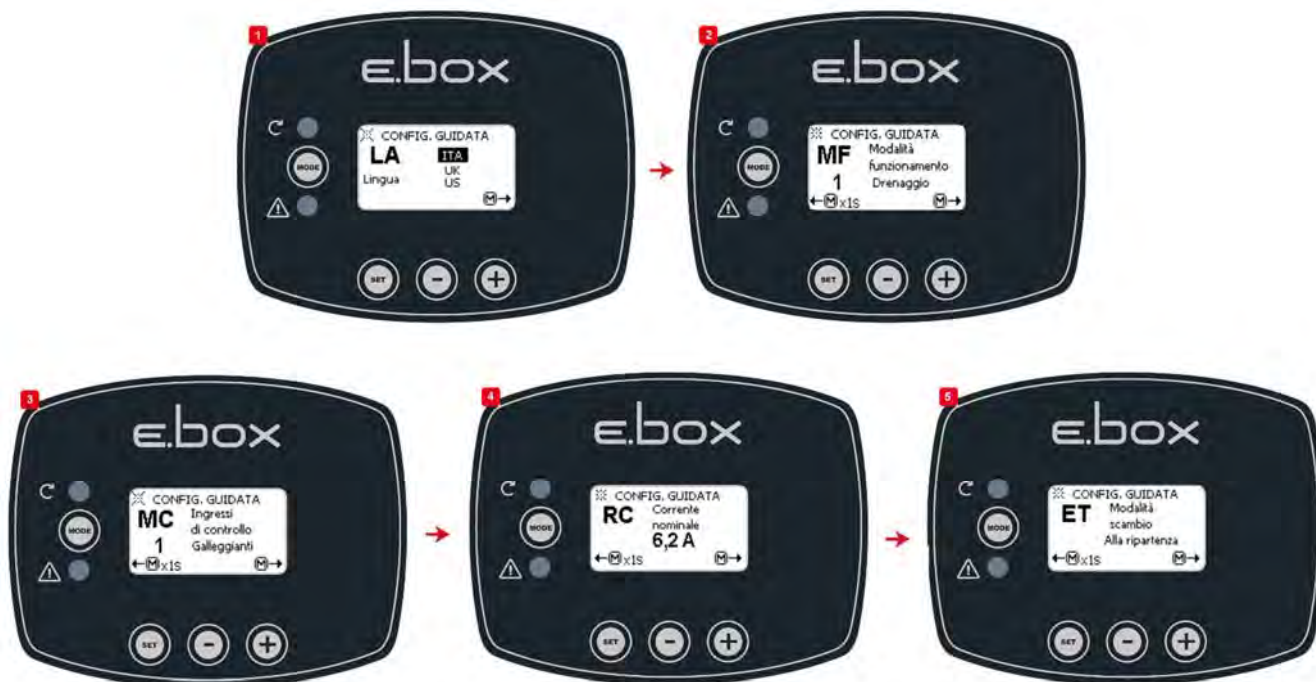
Rysunek 36: Konfiguracja pływaków lub sond poziomu Drenażu
