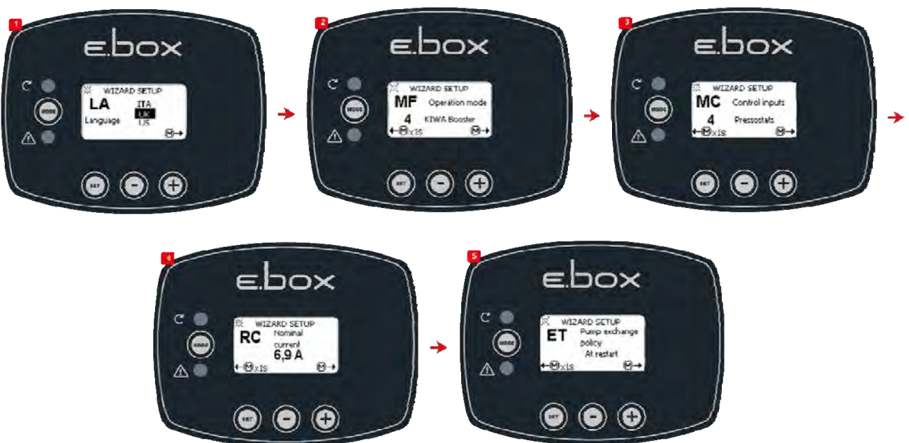
Abbildung 49: Konfiguration KIWA mit Druckwächtern
