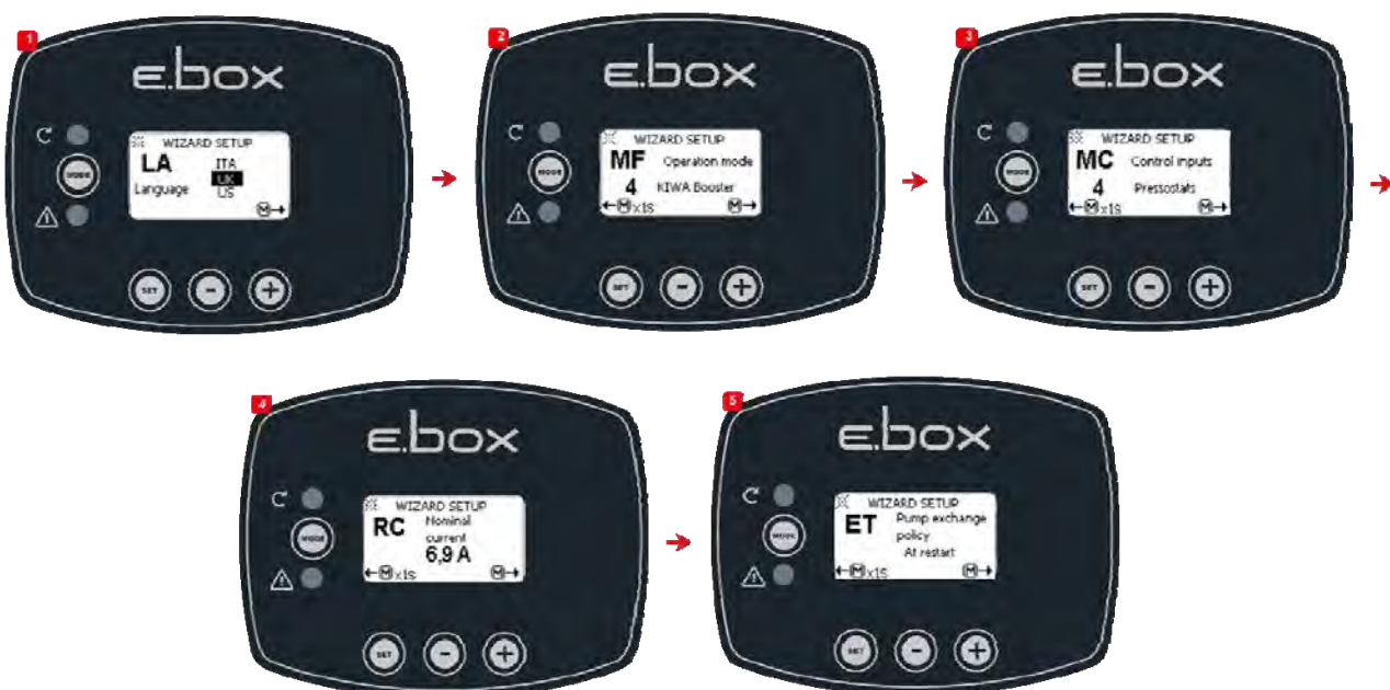
Figura 49: Configurare KIWA cu Presostați
