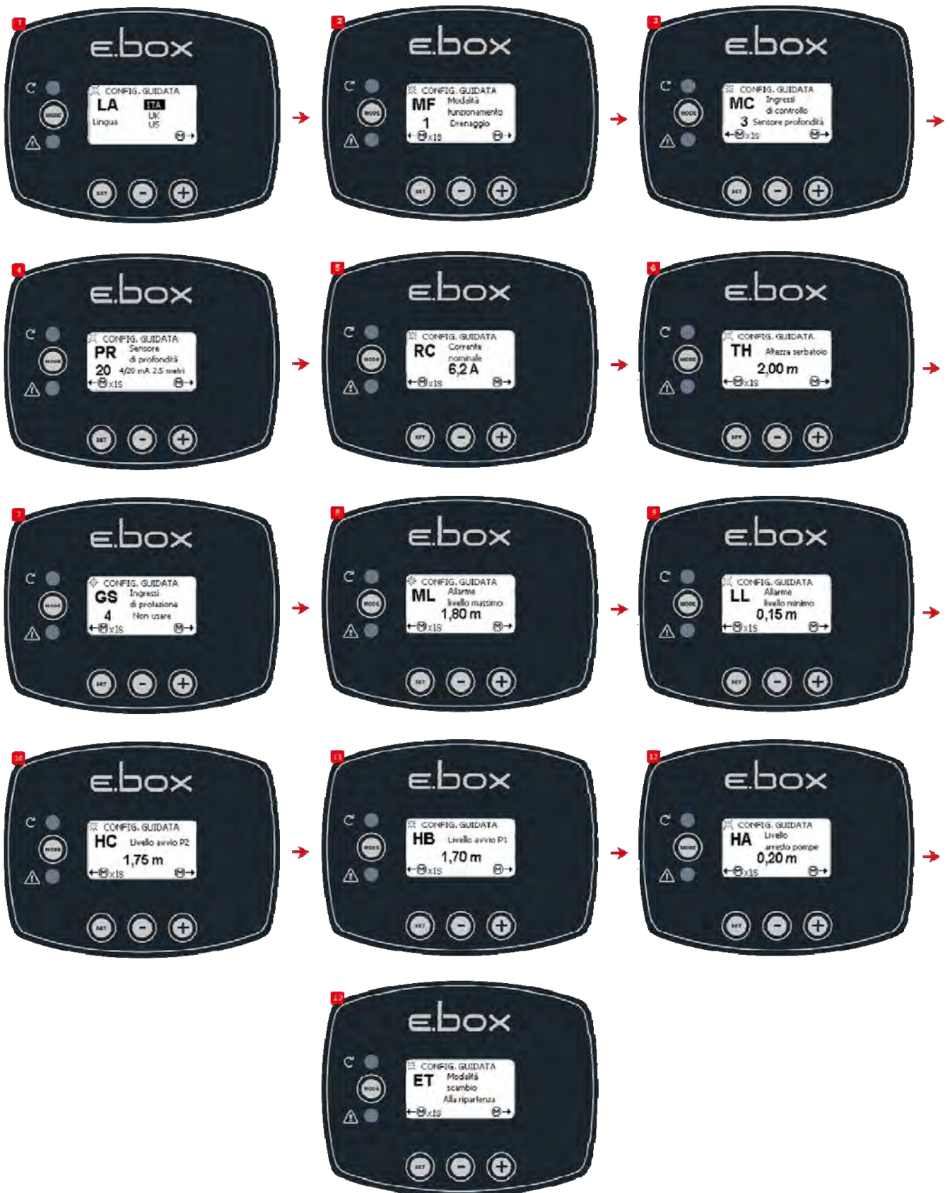
Afbeelding 38: Configuratie met alleen dieptesensor
