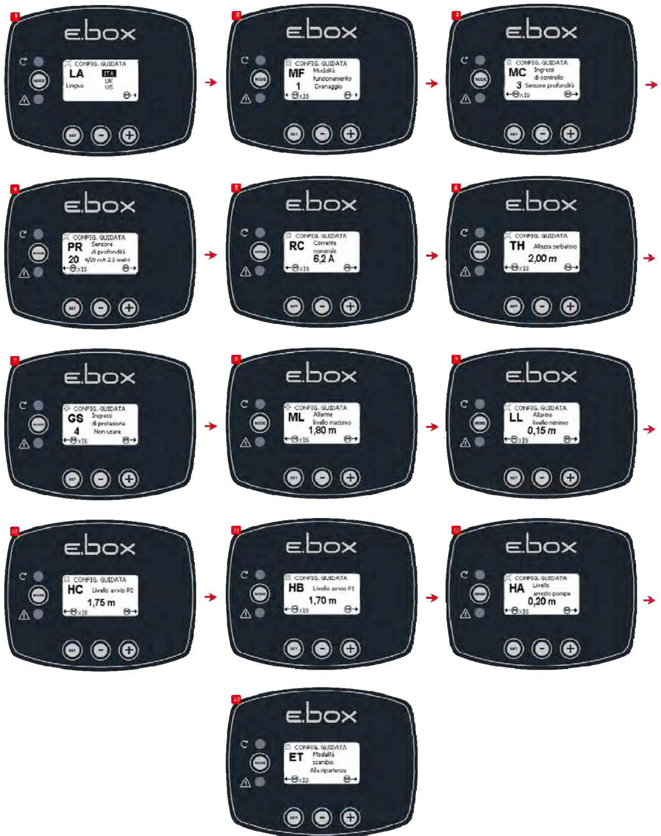
Figura 38: Configuración sólo con sensor de profundidad
