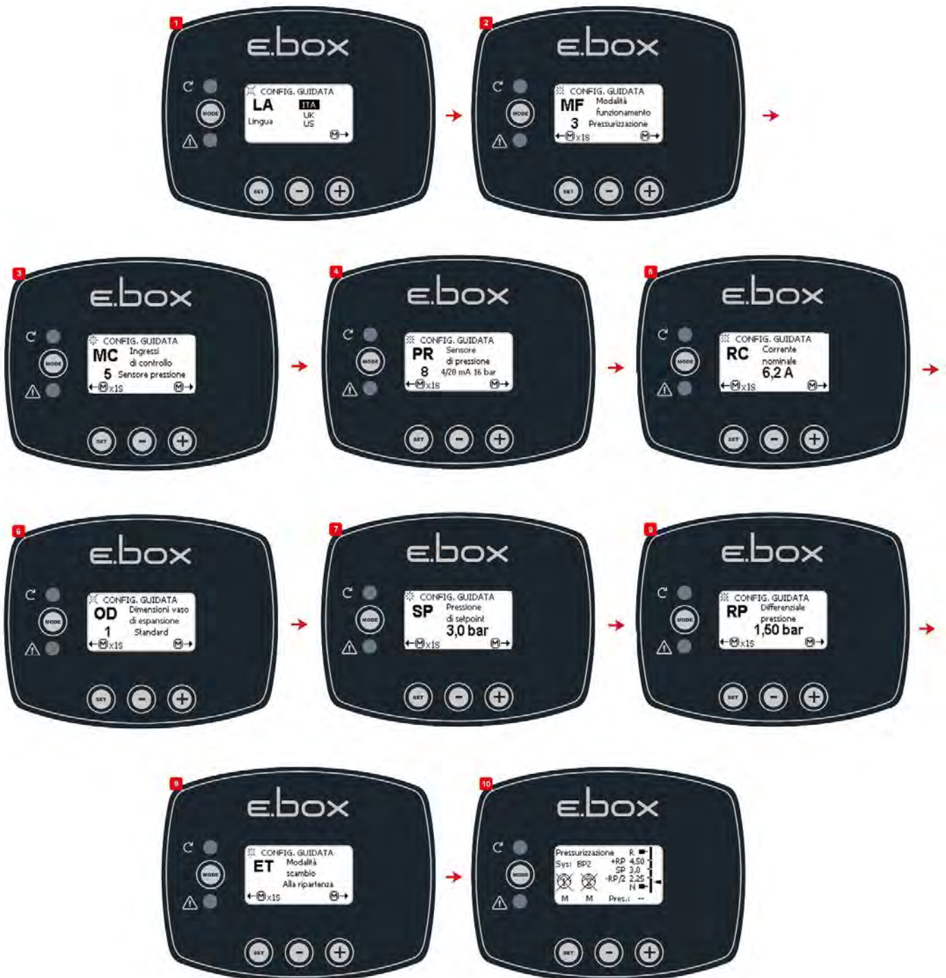
Figure 12 : Configuration avec capteur de pression
