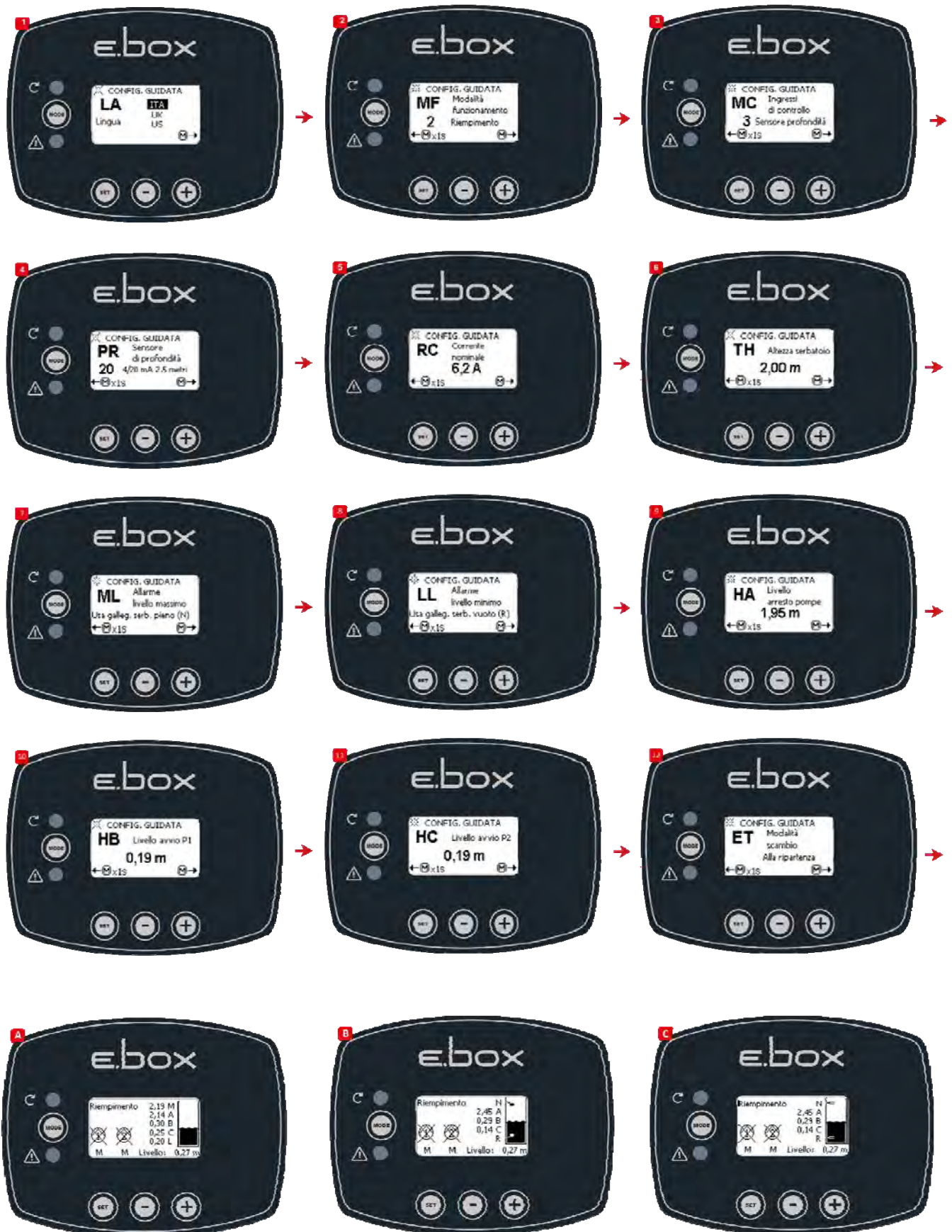
Abbildung 26: A Status des Systems mit nur dem Tiefensensor, B Tiefensensor und Schwimmerschalter, C Tiefensensor und Standsonden.
