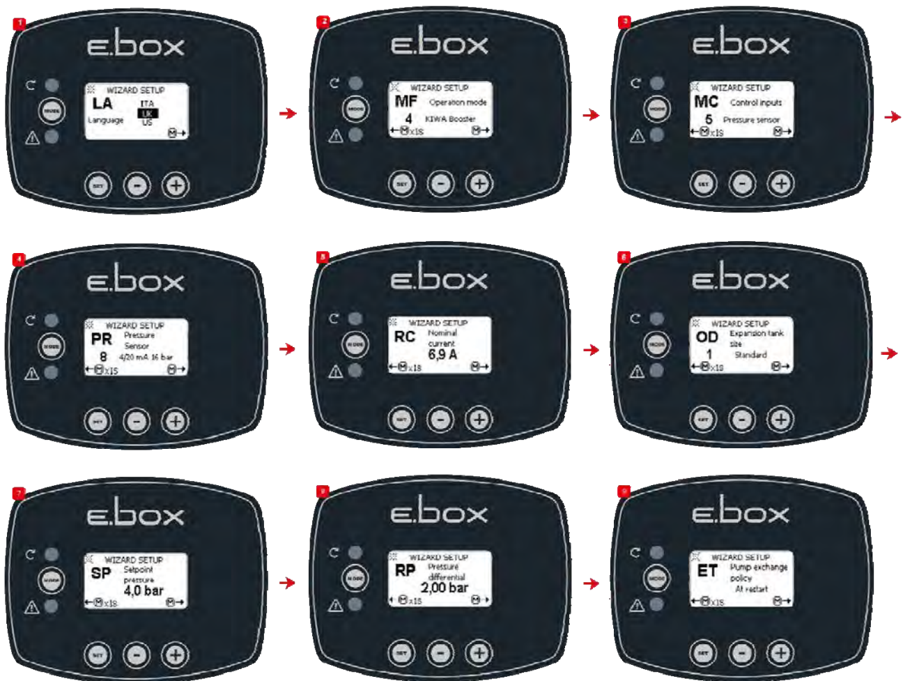
Afbeelding 48: Drukopbouw KIWA met druksensor
