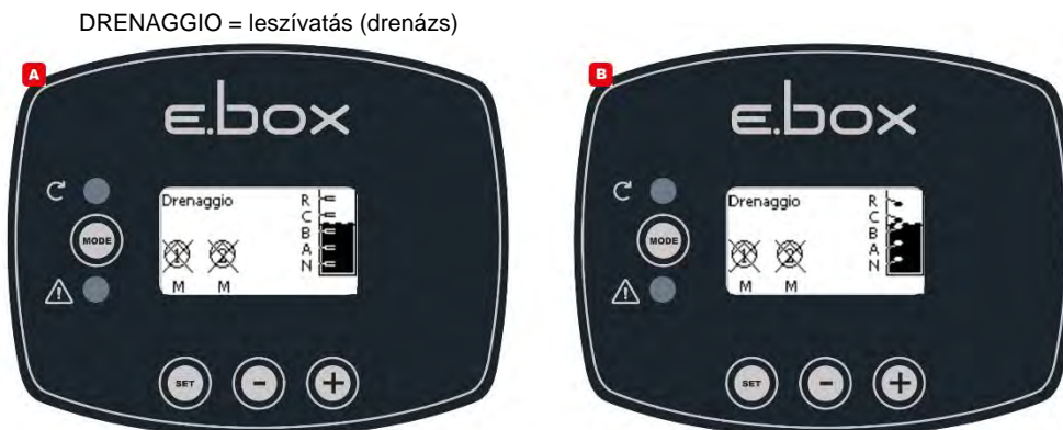
37.ábra: A rendszer státusza drenázs módban: A= szintszondákkal B= úszókapcsolókkal
