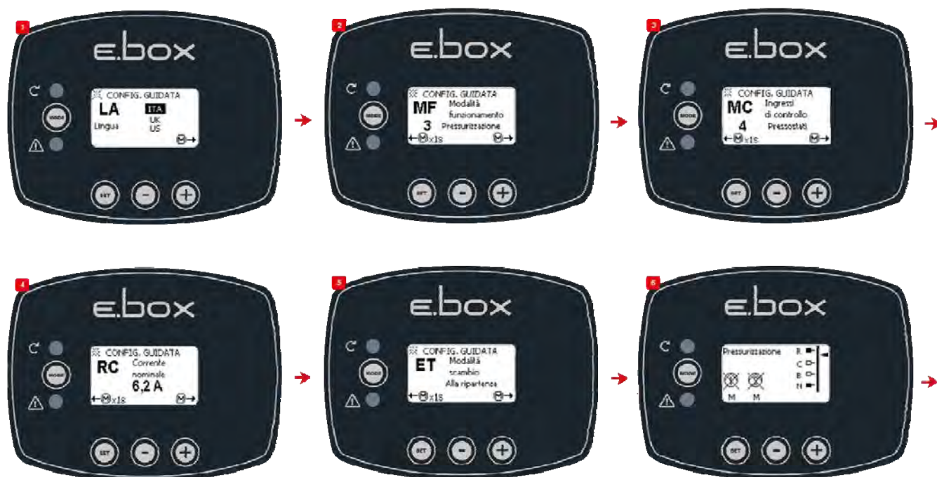
Figura 13: Configurare cu Presostați
