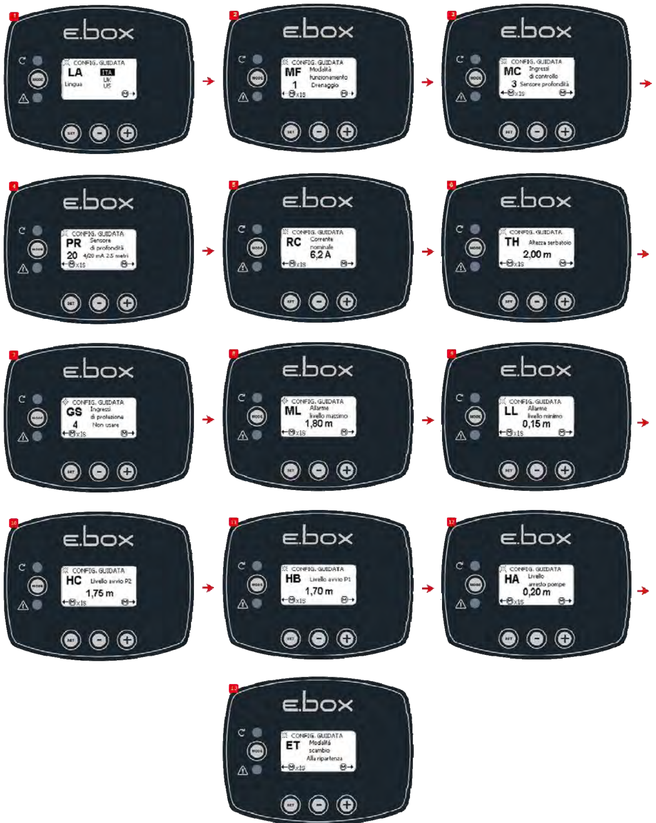
Abbildung 38: Konfiguration mit nur dem Tiefensensor
