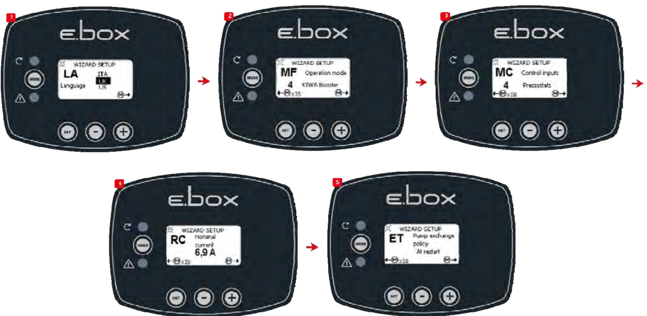
Figura 49: Configuración Kiwa con presostatos
