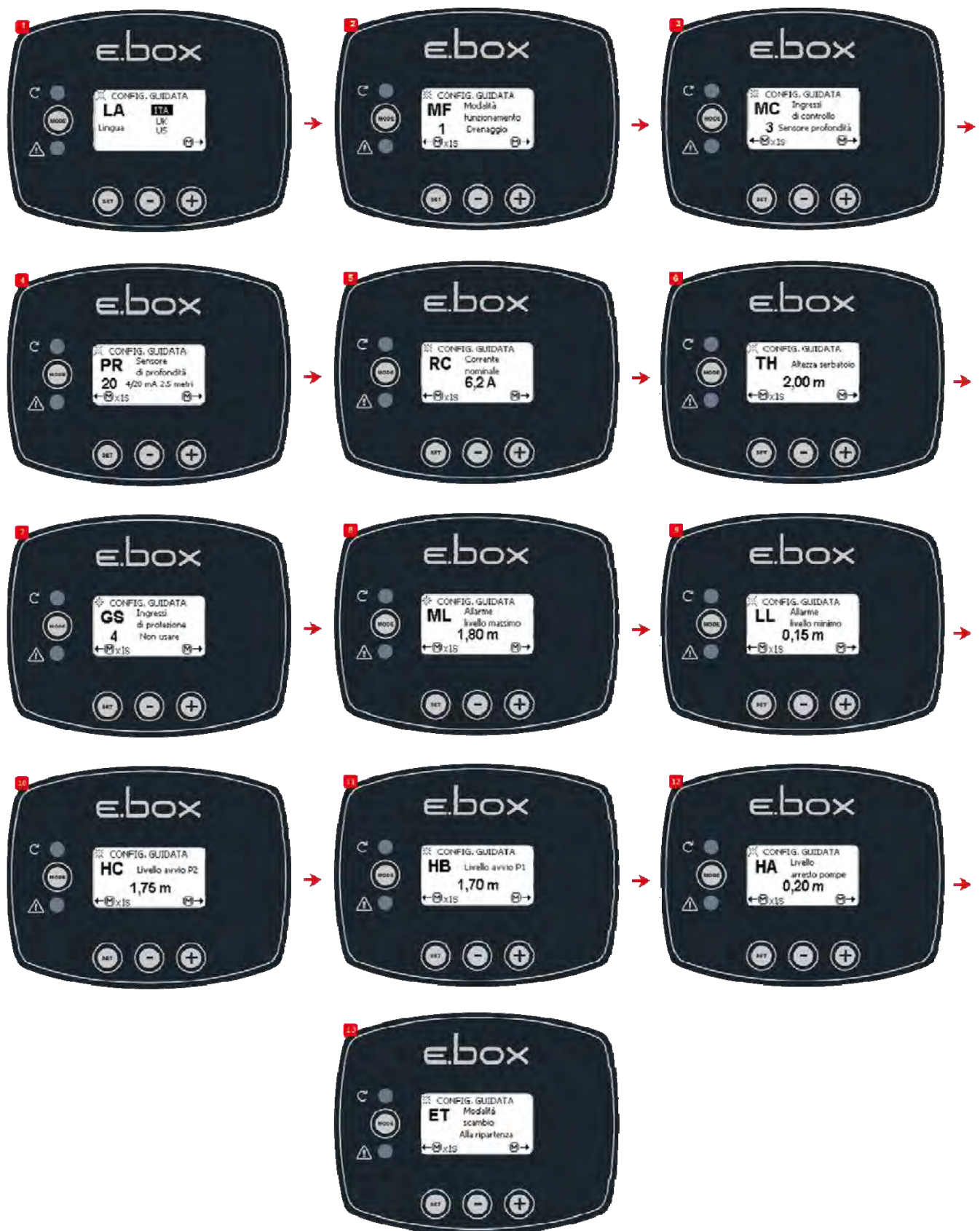
Схема 38: Конфигурация только с датчиком глубины
