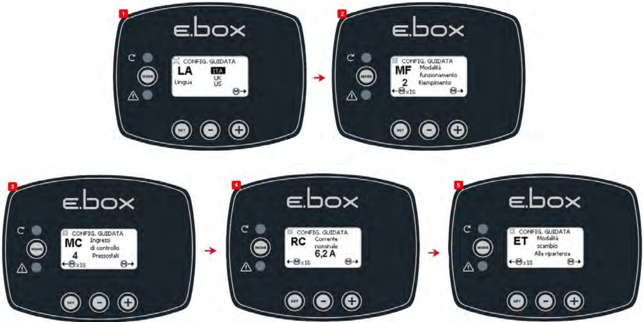
Afbeelding 24: Configuratie Vullen met vlotters of niveaivoelers
