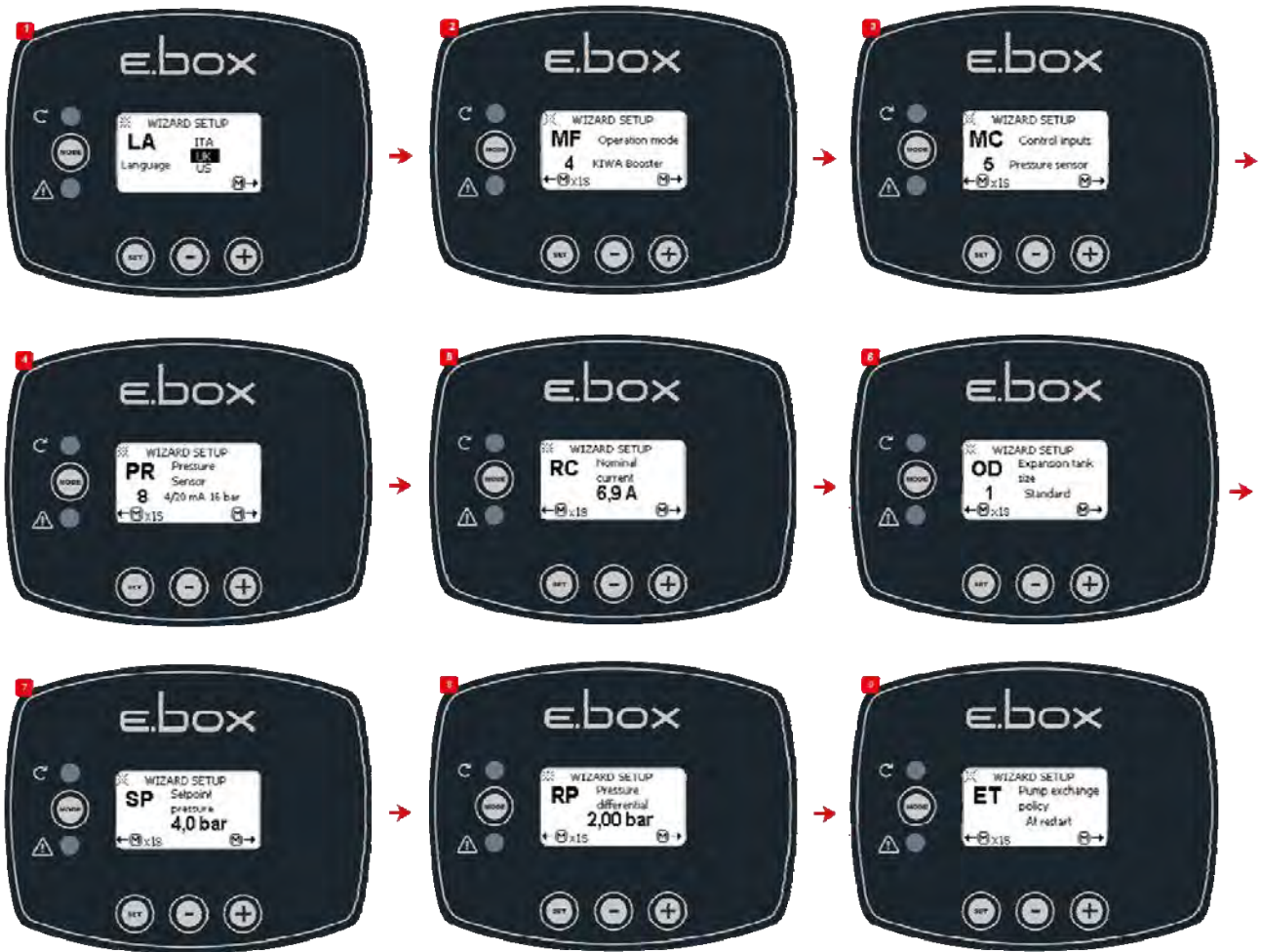
Figura 48: Presurización KIWA con sensor de presión
