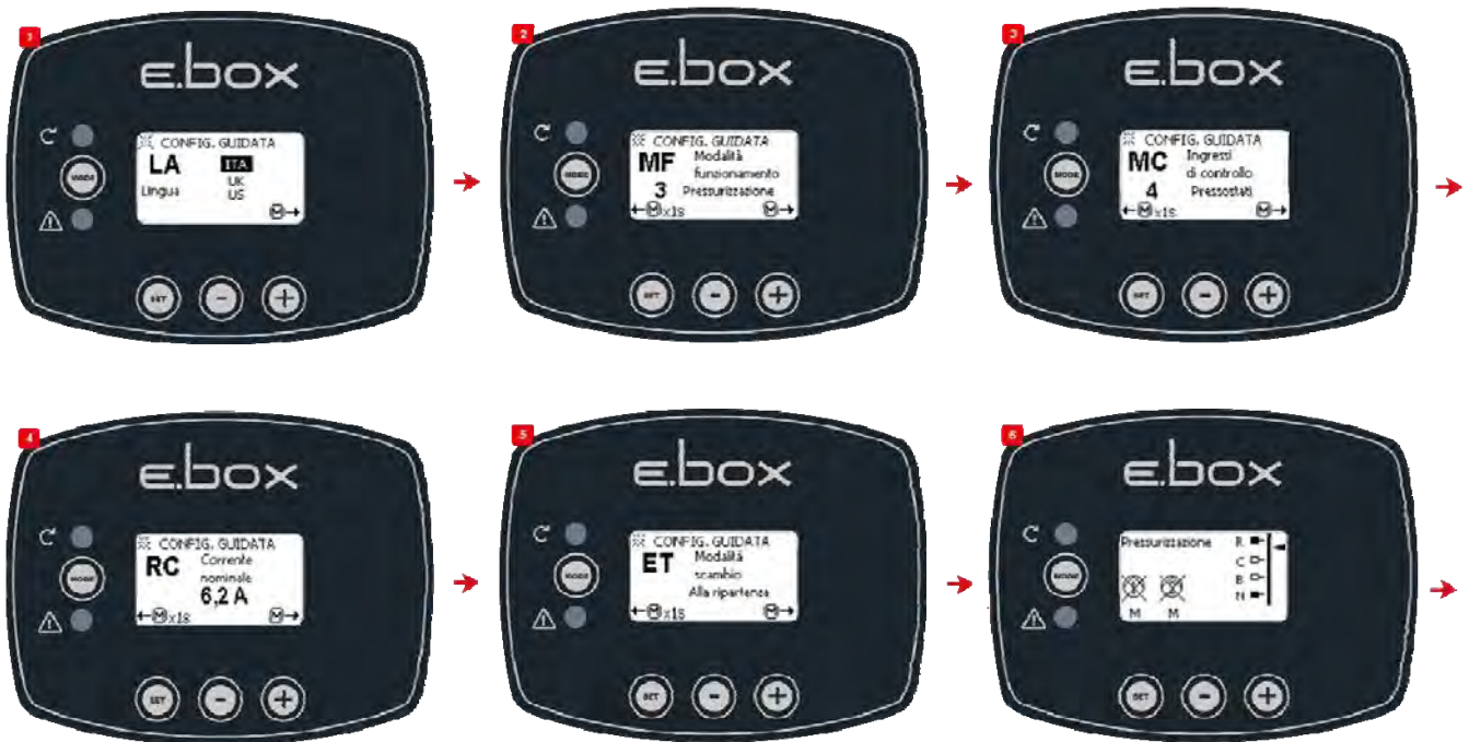
Afbeelding 13: Configuratie met drukschakelaars
