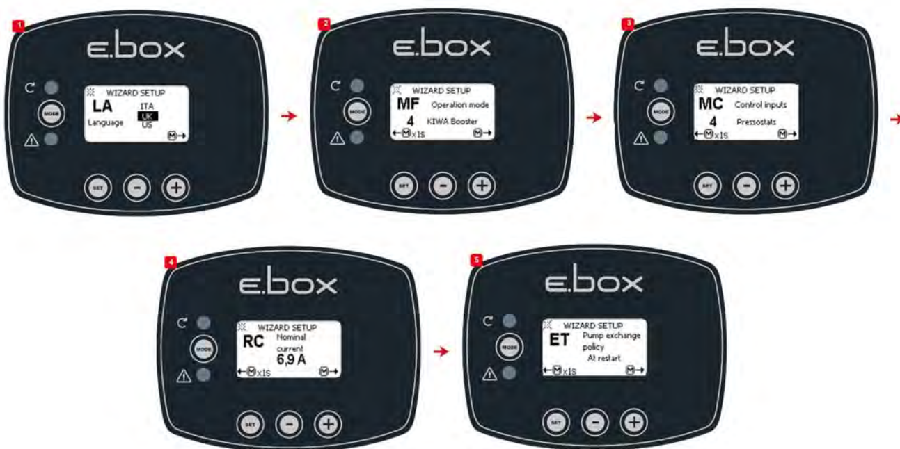
Rysunek 49: Konfiguracja KIWA za pomocą przełączników ciśnienia
