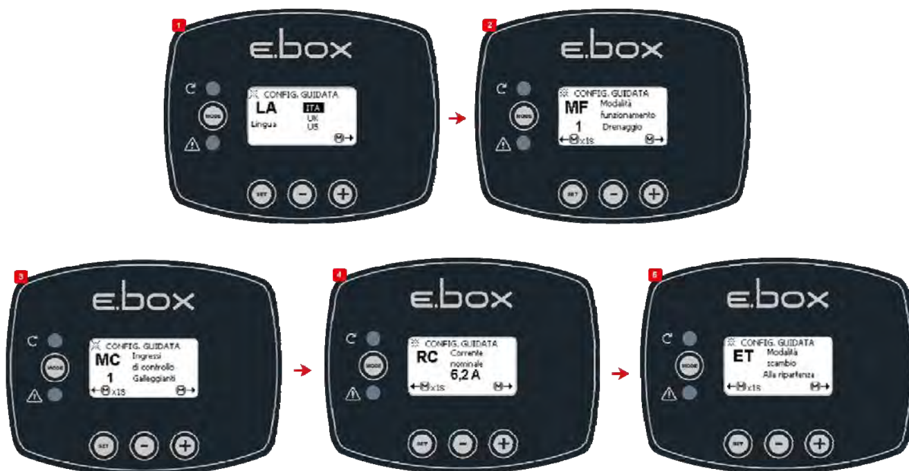
Εικόνα 36: Διαμόρφωση πλωτήρων ή αισθητηρίων στάθμης στην αποστράγγιση
