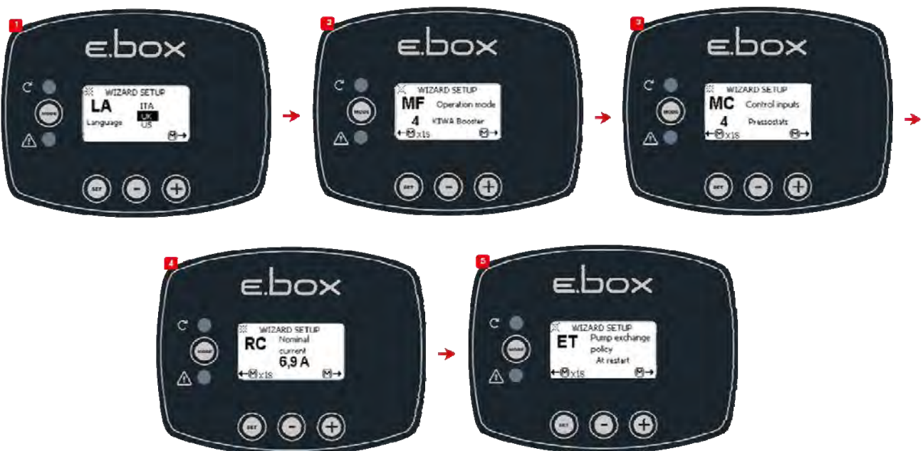
Figure 49 : Configuration KIWA avec des pressostats
