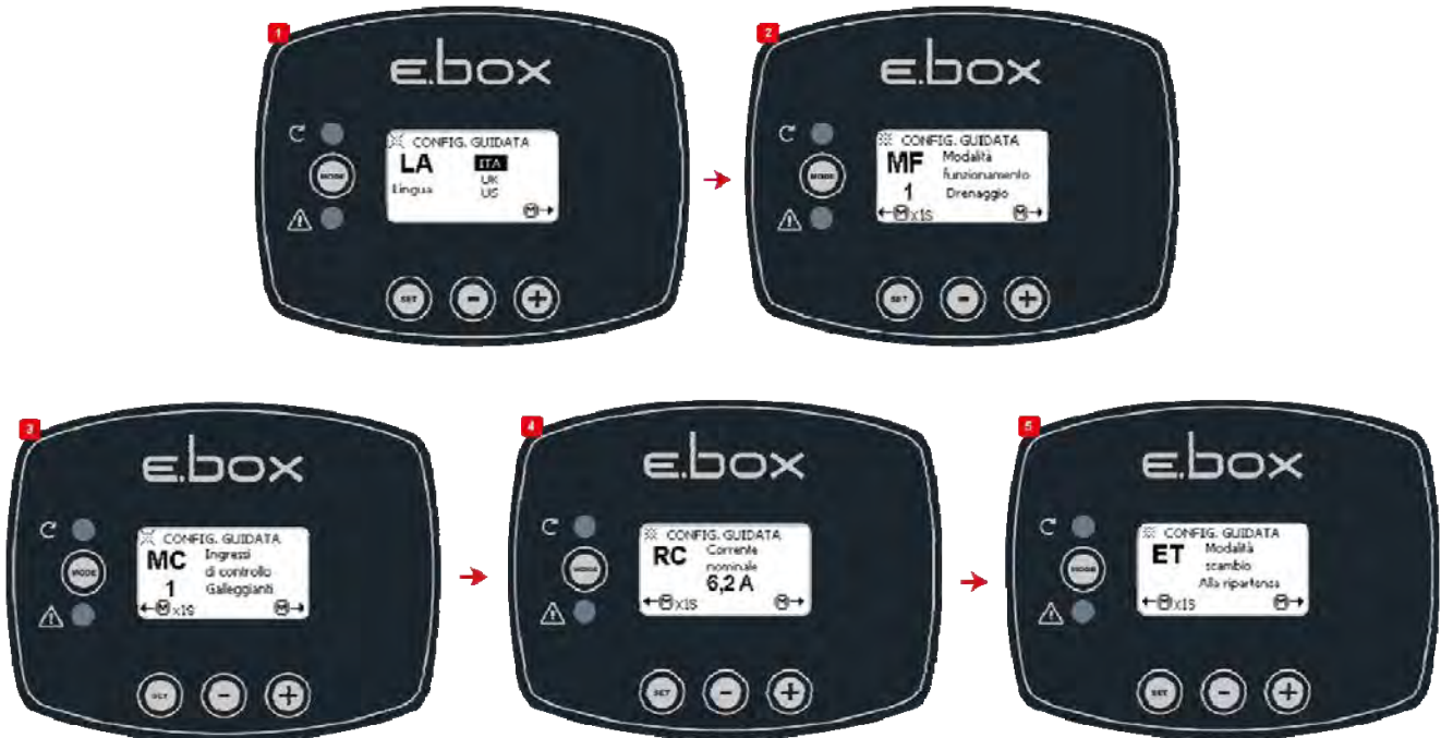
Afbeelding 36: Configuratie Ontwatering met vlotters of niveaivoelers
