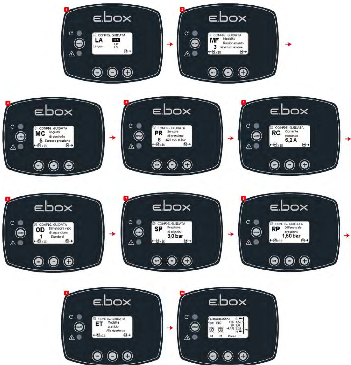
Afbeelding 12: Configuratie met druksensor
