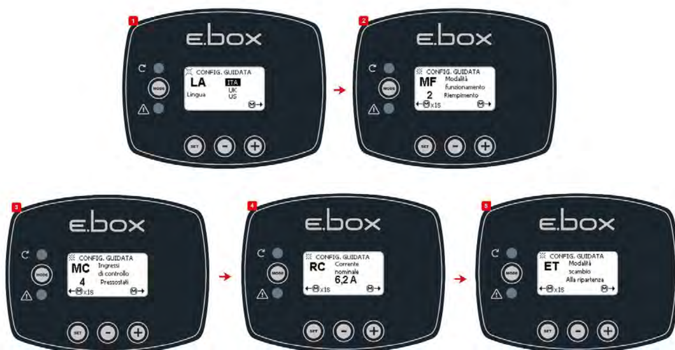
Εικόνα 24: Διαμόρφωση πλήρωσης με πλωτήρες ή αισθητήρια στάθμης
