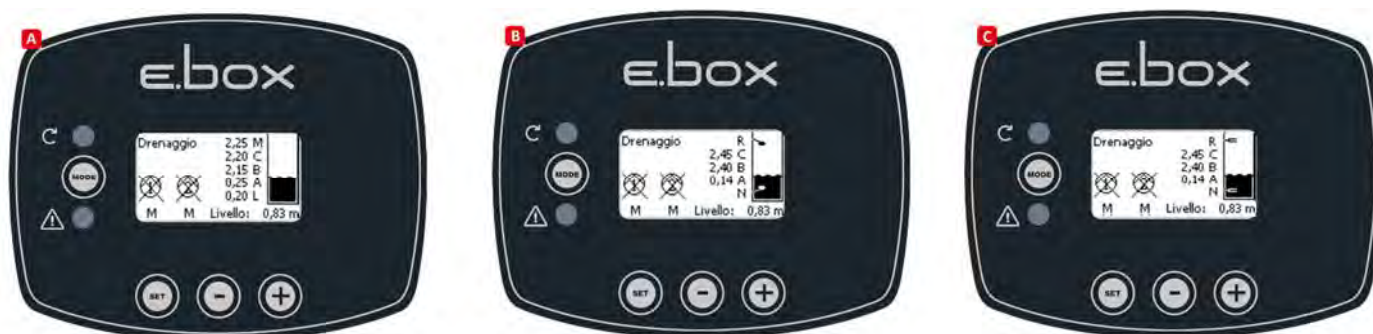
Rysunek 39: Stan układu tylko z czujnikiem głębokości, B z czujnikiem głębokości i pływakami, C z czujnikiem głębokości i sondami poziomym
