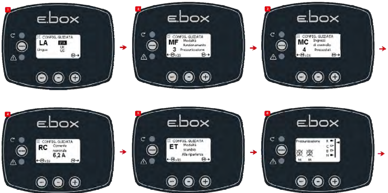
Abbildung 13: Konfiguration mit Druckwächtern
