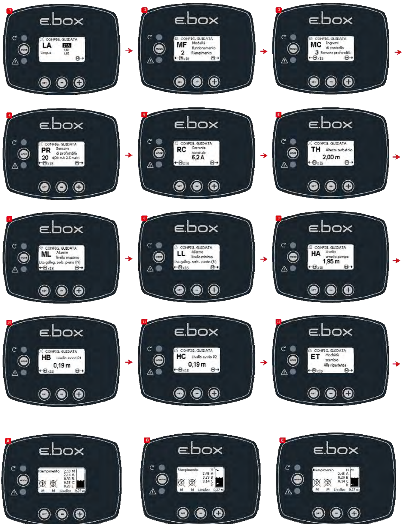
Εικόνα 26: A Κατάσταση του συστήματος μόνο με αισθητήρα βάθους, B αισθητήρας βάθους, C αισθητήρας βάθους και αισθητήρια στάθμης
