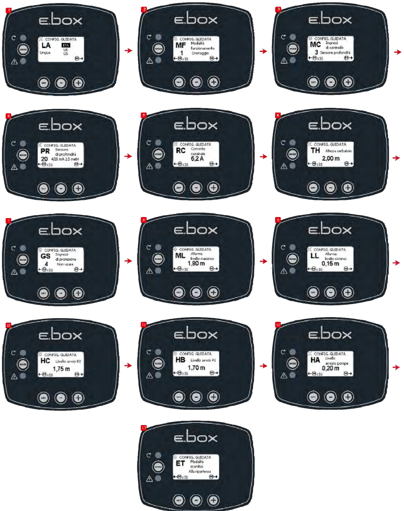
Figure 38 : Configuration avec capteur de profondeur uniquement
