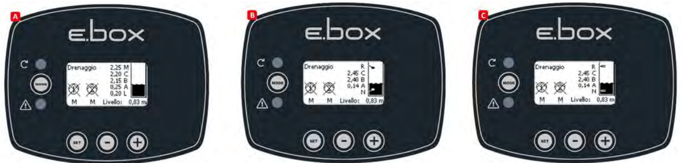
Figura 39: Stato del sistema nelle configurazioni: A solo sensore di profondità, B: sensore di profondità e galleggianti, C sensore di profondità e sonde di livello
