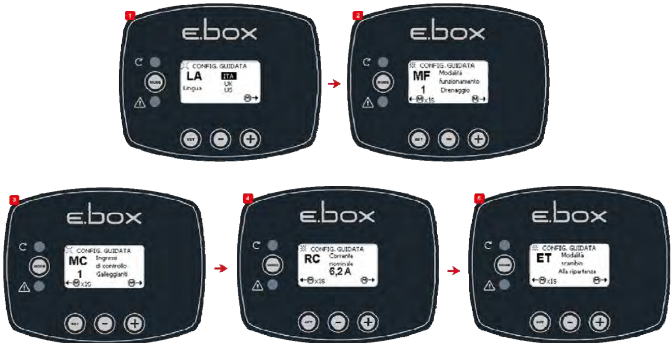
Obrázek 36: Nastavení vypouštění pomocí plováků nebo hladinových čidel
