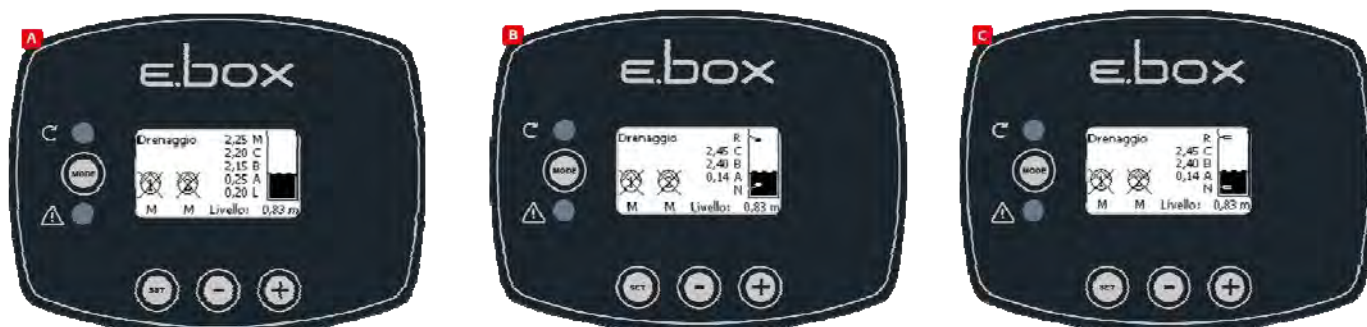
Figure 39 : État du système dans les configurations : A un capteur de profondeur uniquement, B capteur de profondeur et flotteurs, C capteur de profondeur et sondes de niveau
