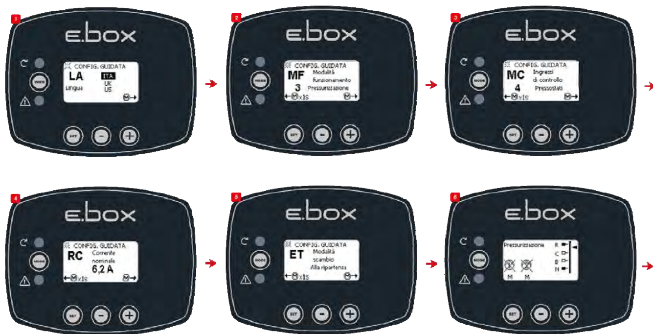
Εικόνα 13: Διαμόρφωση με Πιεσοστάτες
