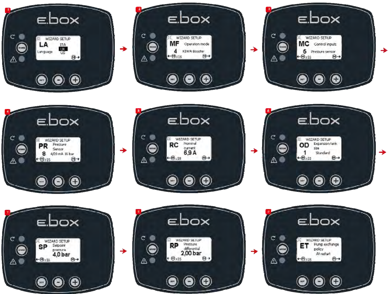
Abbildung 48: KIWA Druckerhöhung mit Drucksensor
