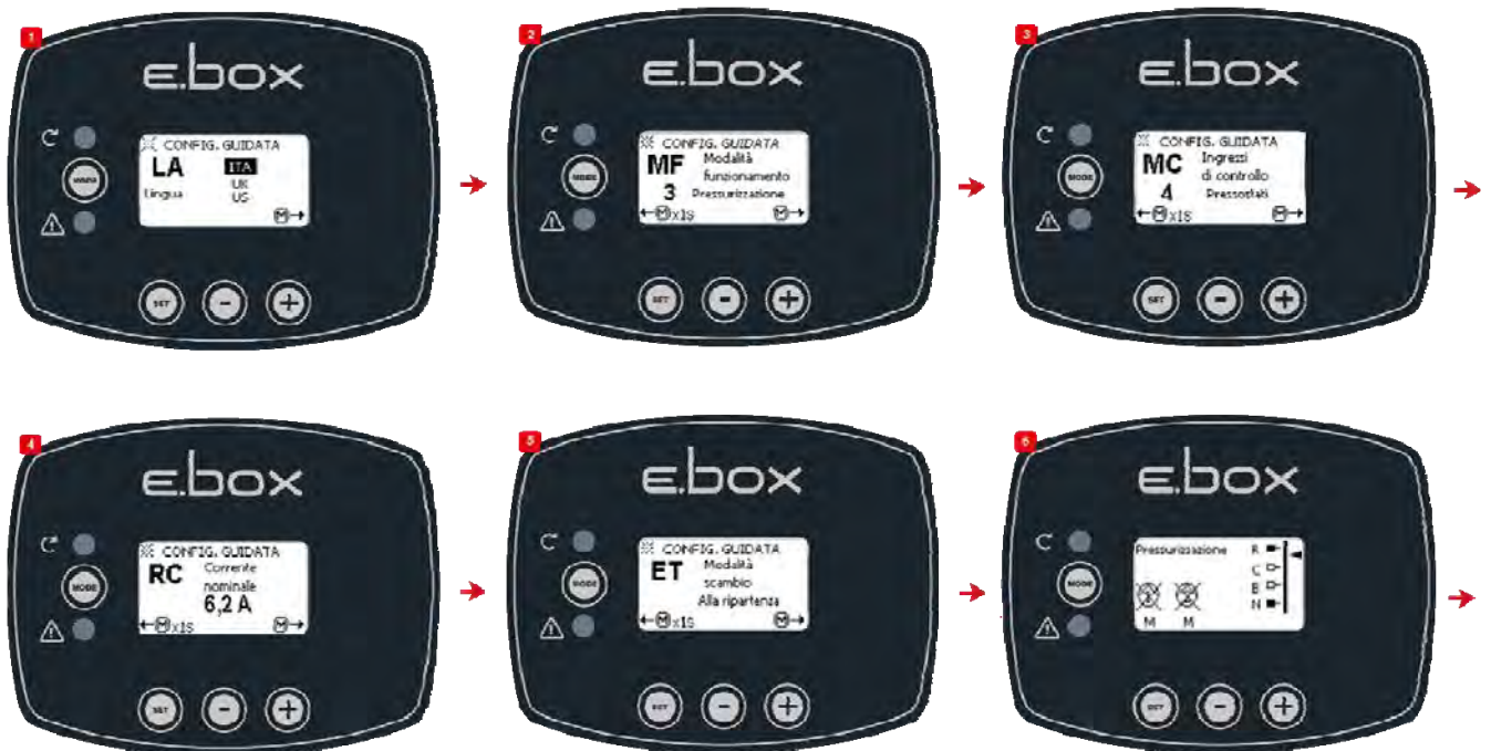
Figure 13 : Fonctionnement avec des pressostats
