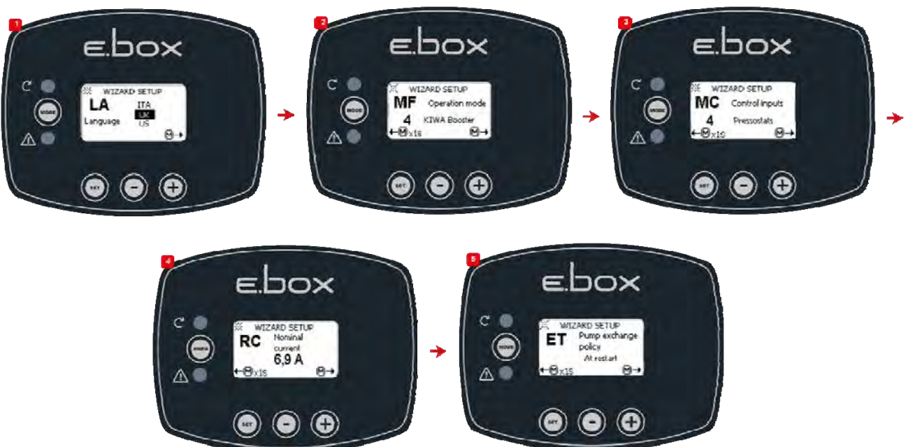
Obrázek 49: Kiwa nastavení s tlakovými spínači
