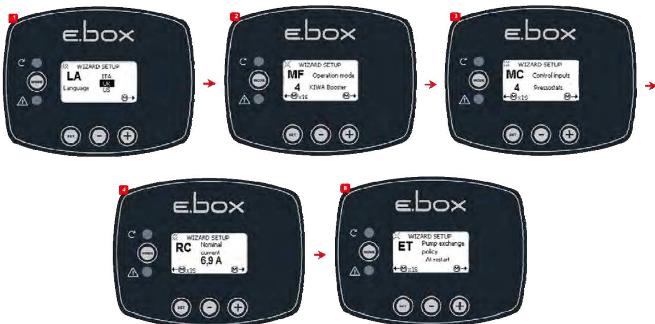
Εικόνα 49: Διαμόρφωση KIWA με Πιεσοστάτες
