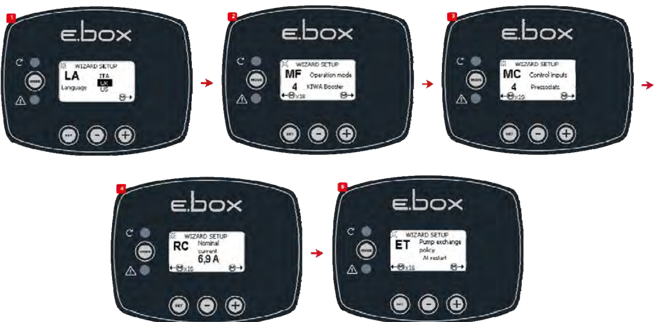
Схема 49: Конфигурация KIWA с реле давления
