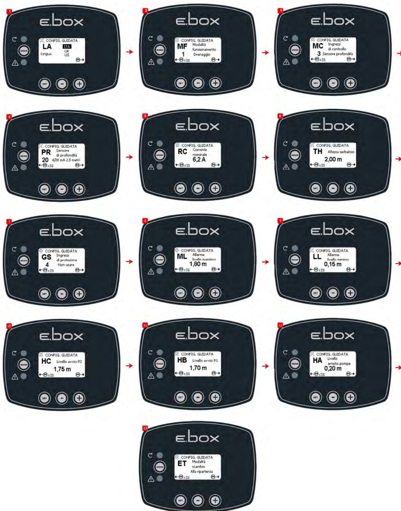
Rysunek 38: Konfiguracja tylko z czujnikiem głębokości
