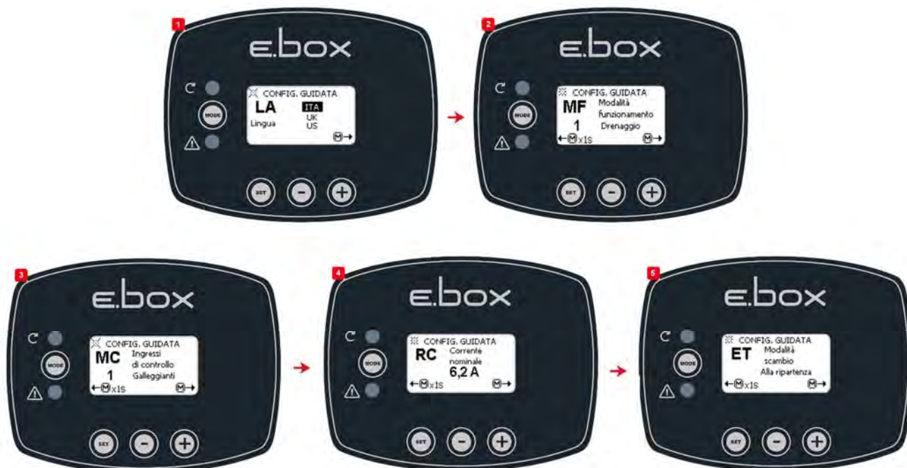
Figura 36: Configurazione Drenaggio galleggianti o sonde di livello
