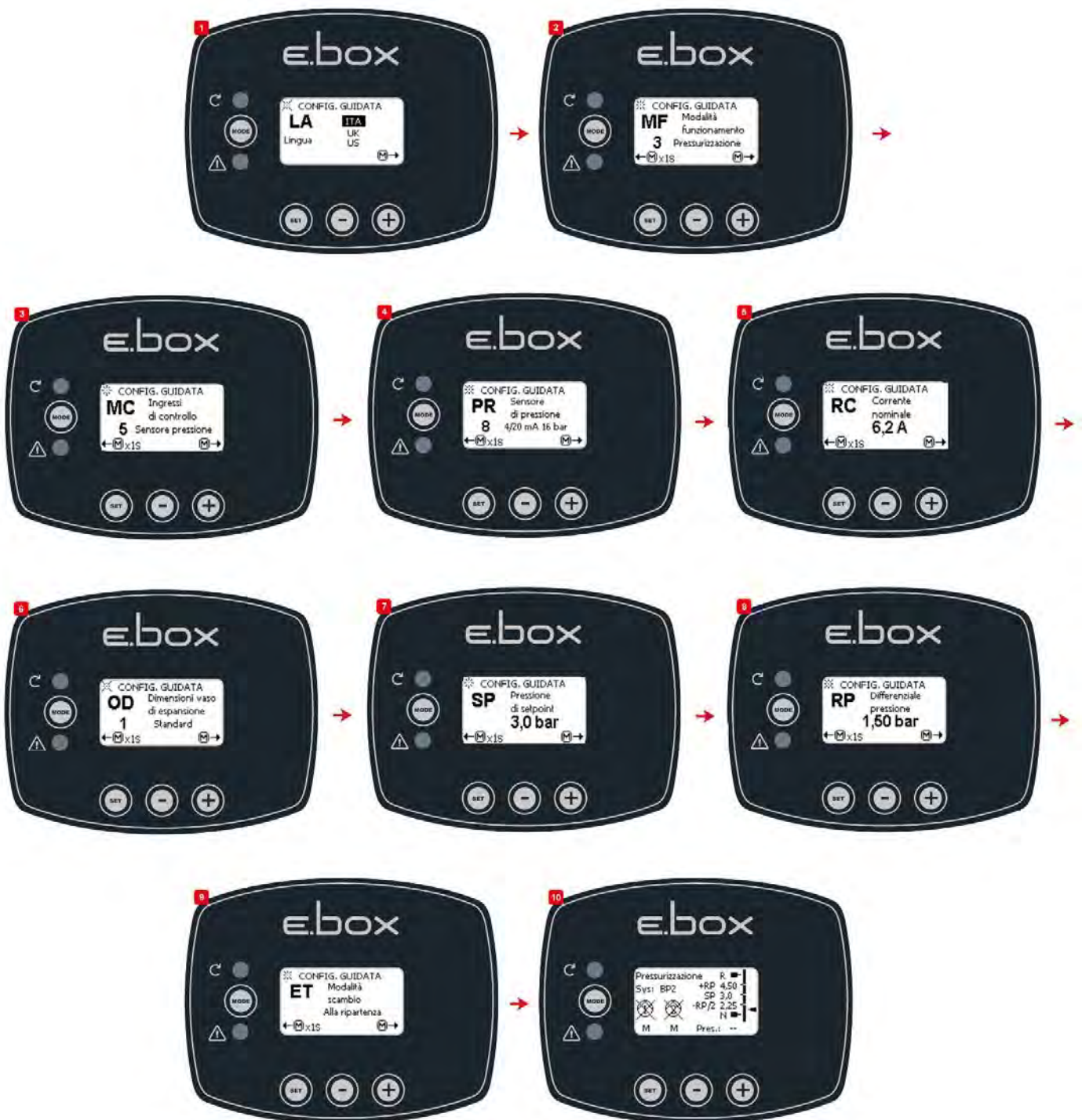
Figura 12: Configuración con sensor de presión
