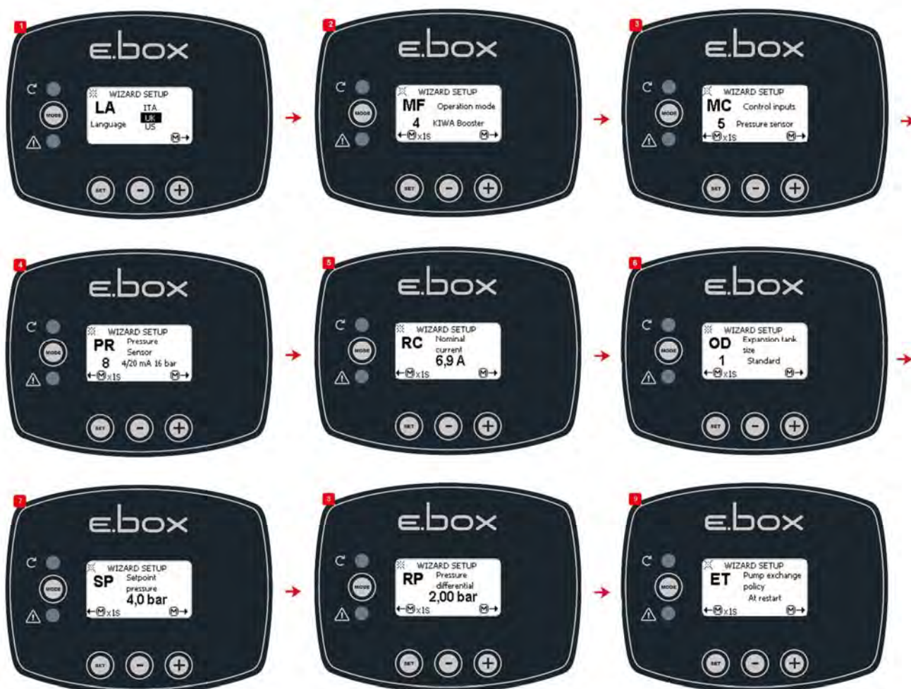
Figura 48: Pressurizzazione KIWA con sensore di pressione
