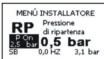
Рисунок 19: Настройка давления нового включения
