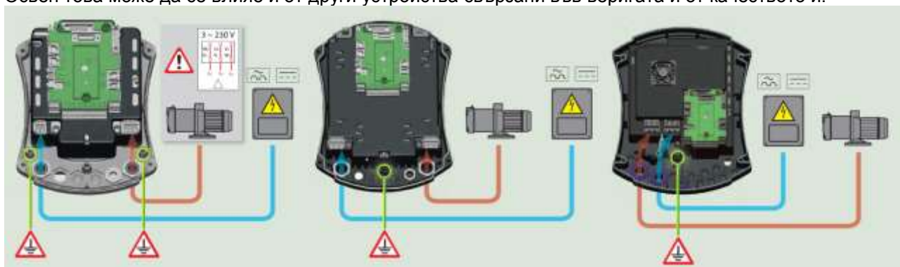
Фиг. 5: Електрически връзки
