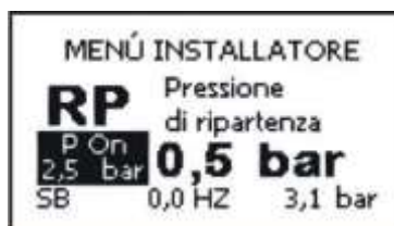
Рисунок 18: Настройка давления нового включения
