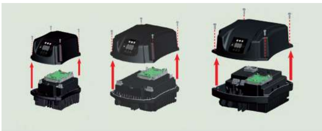
Figura 2: Demontarea capacului pentru accesul la conexiuni
