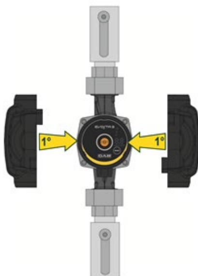
Figura 7: Isolamento do corpo da bomba
