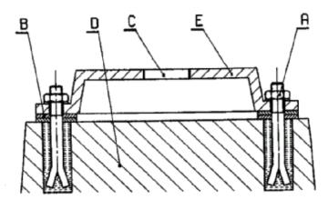
Между прокладками, фундаментом и насосной плитой не должно быть зазоров перед затяжкой крепежных болтов. Все прокладки должны прилегать плотно.
