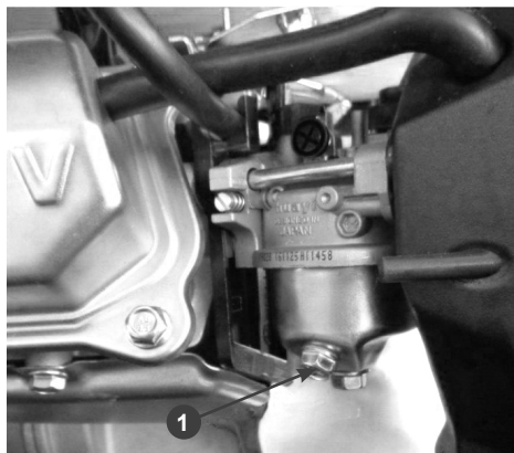
Рис. 17 Обслуживание поплавковой камеры карбюратора 1. Сливной болт
