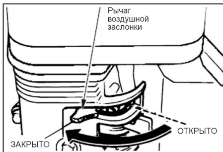
Рис.19 Установка рычага воздушной заслонки
