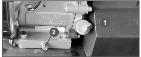
Рис.28 Замена моторного масла
