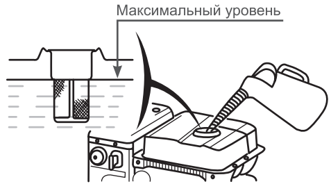
Рис. 6 Максимальный уровень топлива в топливном баке
