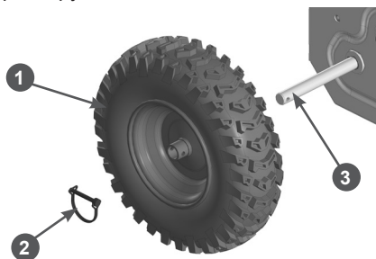
Рис. 7. Установка правого колеса
