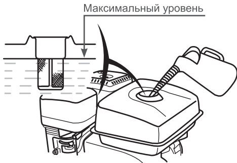
Рис. 20. Максимальный уровень топлива в топливном баке
