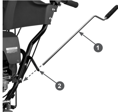
Рис. 26 Установка рычага управления поворотом жёлоба
