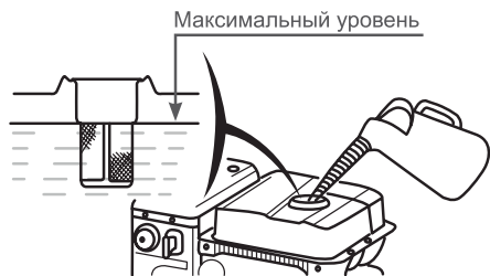
Рис. 31 Максимальный уровень топлива в топливном баке
