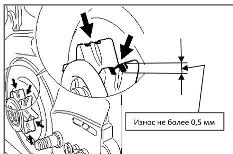
Рис.10 Проверка износа звездочки
