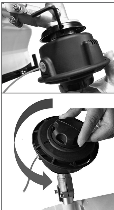
Рис. 5 Установка триммерной головки
