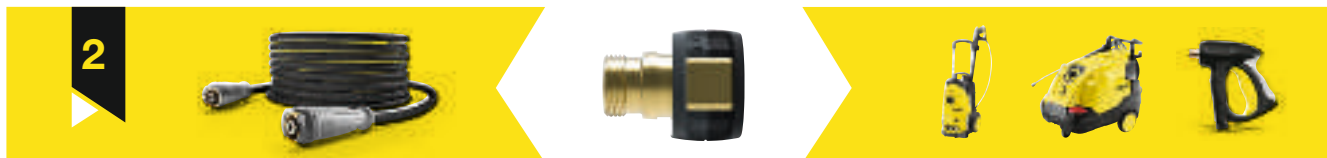
EASY!Lock – M 22×1,5 № д. зак. 4.111-030.0 Адаптер для соединения аппаратов высокого давления / пистолетов с разъемом M 22×1,5 и шлангов с разъемом EASY!Lock.
