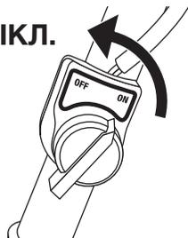
Переведите рычаг останова двигателя на выключателе в положение OFF («выключено»).
