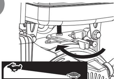
Сдвиньте рычаг дроссельной заслонки или рычаг управления скоростью до МЕДЛЕННОГО (значок «черепаха»).
