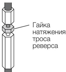
**Б** Отрегулируйте натяжение так, чтобы конец рычага реверса имел свободный ход 5 мм
