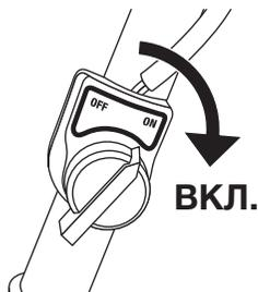
Переведите рычаг останова двигателя на выключателе в положение ON («включено»).
