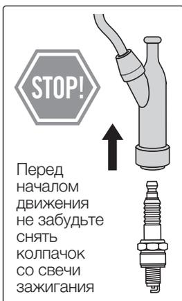
Перед началом движения не забудьте снять колпачок со свечи зажигания
