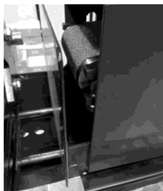
Рис. 10: Накрытие переднего шлифовального валика.
