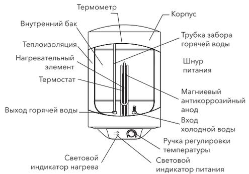
Рис. 1. Устройство прибора
