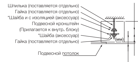
Подготовка места установки блока в подвесном потолке
