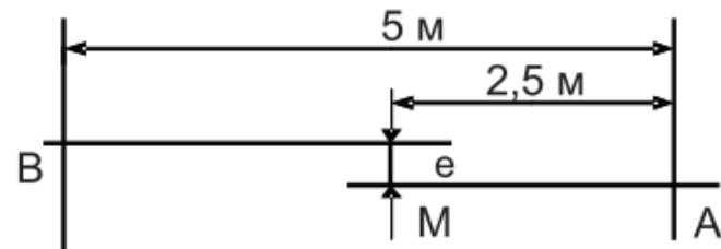
Повернуть лазерный построитель так, чтобы сместить луч приблизительно на 2,5м влево и проверить, чтобы горизонтальная линия находилась в пределах значения „точность” (см. характеристики) на той же высоте, что и нанесенная отметка, указанная лазерным крестом. Повторить эти же действия , смещая лазерный инструмент вправо. Внимание: ось вращения при проверке точности не смешайте.
