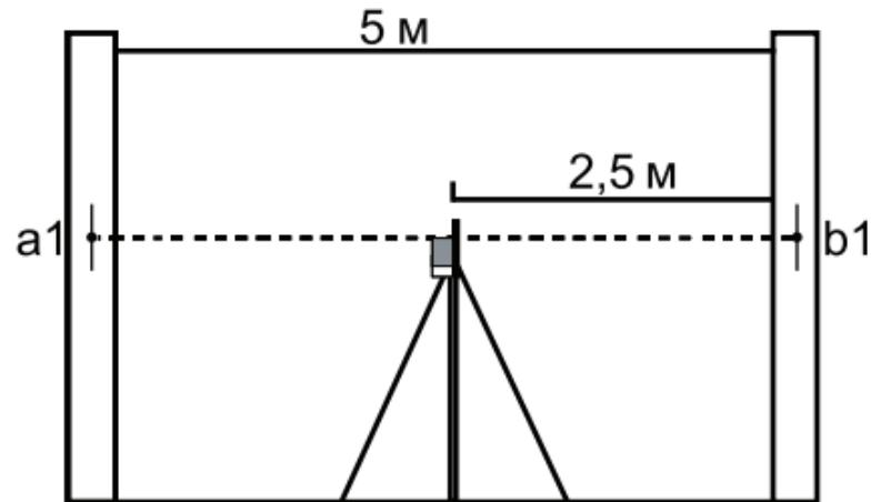
Пример: При проведении проверки лазерного построителя плоскостей, разница:  $\{a_1-a_2\} = 5$  мм и  $\{b_1-b_2\} = 7$  мм. Таким образом полученная погрешность прибора:  $\{b_1 - b_2\} - \{a_1-a_2\} = 7-5 = 2$  мм. Теперь Вы можете сравнить полученную погрешность, с величиной погрешности, заданной производителем. Если точность лазерного построителя не соответствует заявленной, необходимо обратиться в авторизованный сервисный центр.
