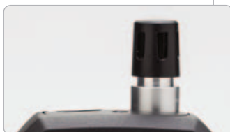
Добавление показаний уровня влажности к ИК-сняткам в режиме реального времени
