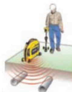
Обнаружение с помощью линейного передатчика (индукционный режим)
