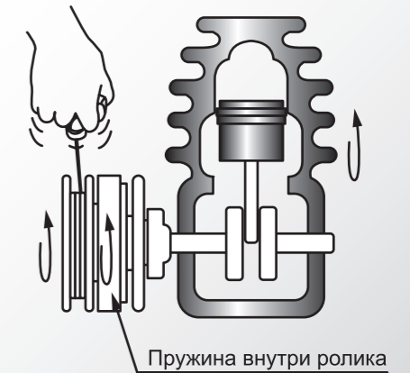
4 Схема работы системы легкого запуска i-start
