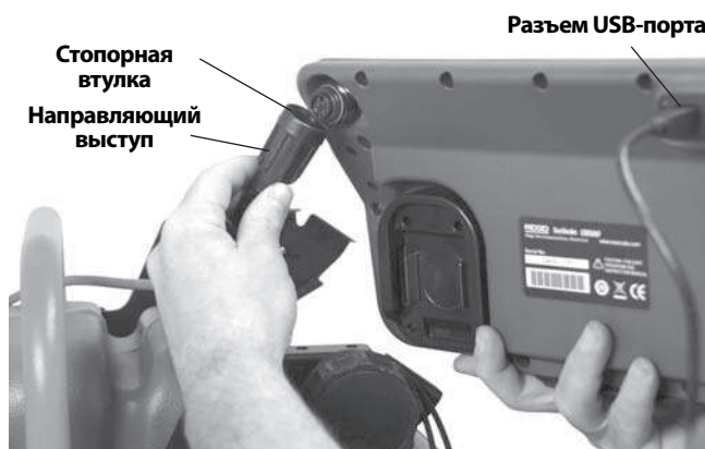
Рис. 12 – Крепление системного кабеля SeeSnake
