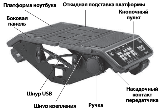
Рис. 1 – Откидные подставки платформы в сложенном состоянии
