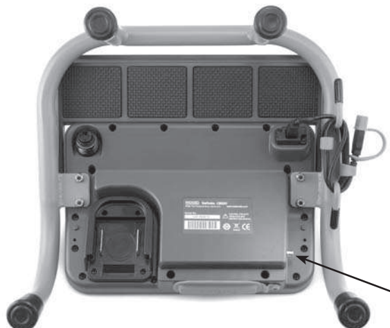
Рис. 27 – Насадочный контакт передатчика прибора LT1000
