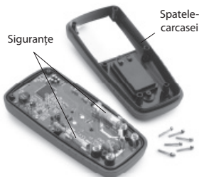
Figura 9 – Scoaterea spatelui carcasei multimetrului
