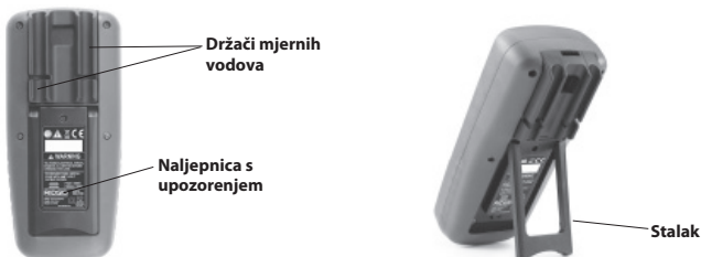
Slika 2 – Poledina digitalnog multimetra DM-100
