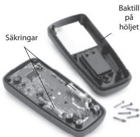
Figur 9 – Demontering av multimeterns baksida
