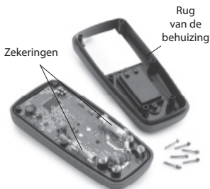
Figuur 9 – De rug van de multimeterbehuizing afnemen
