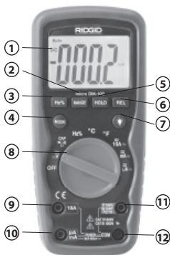
Figura 3 – Comandi del Multimetro digitale DM-100
