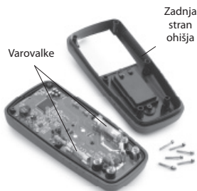
Slika 9 – Odstranjevanje zadnje strani ohišja multimetra
