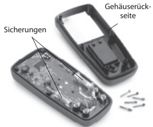
Abbildung 9 – Entfernen der Rückseite des Multimeter-Gehäuses
