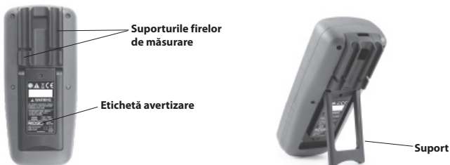
Figura 2 – Spatele multimetrului digital micro DM-100
