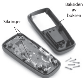
Figur 9 – Fjern baksiden på multimålerdekslet
