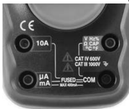
Figura 7 – Terminales de entrada
