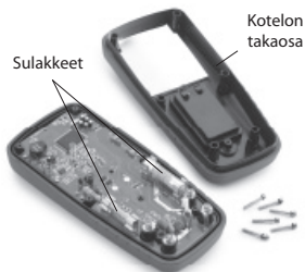
Kuva 9 – Yleismittarin kotelon takaosan irrotus
