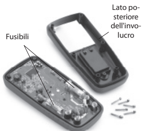
Figura 9 – Rimozione del retro dell'involucro del Multimetro
