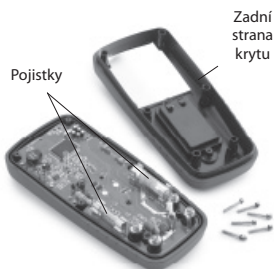
Obrázek 9 – Odstranění zadní strany krytu multimetru
