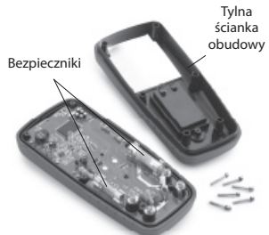
Rys. 9 – Zdejmowanie tylnej ścianki multimetru
