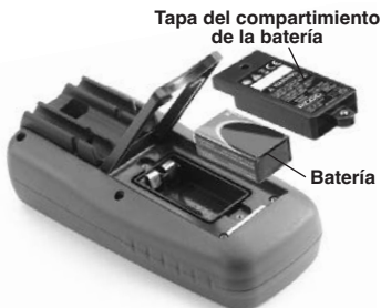
Figura 5 – Reemplazo de la batería
