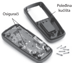
Slika 9 – Uklanjanje pozadine kućišta univerzalnog mernog instrumenta
