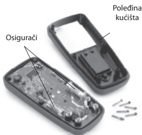
Slika 9 – Skidanje poledine kućišta uređaja
