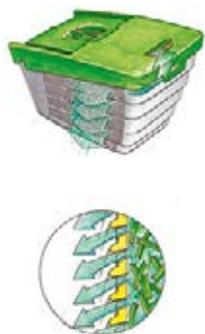
**Запатентованный травосборник:** объем 75 литров, заполняется до отказа благодаря своей оптимизированной форме и подаче воздуха. Воздушные отверстия направлены вниз, чтобы трава и пыль не поднимались вверх. Конструкция сборника из 2 частей обеспечивает легкое открывание и опустошение.
