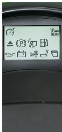
**ЖК-дисплей** отображает ряд параметров: наработку часов эксплуатации, напряжение аккумулятора, готовность травосборника к работе, уровень топлива в баке, момент опустошения травосборника, подключение косилочного механизма, круиз-контроль.
