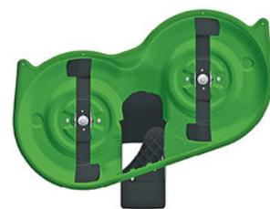
**2-ножевой механизм** (ширина скашивания 95 см) с наклонно установленными ножами существенно улучшает картину стрижки.
