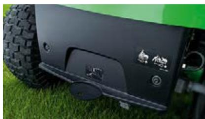
**Встроенное прицепное устройство** обеспечивает простоту установки навесного оборудования (например, прицепа-самосвала PICK UP 300).
