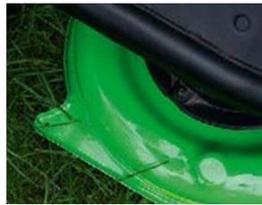
**Направляющая система для травы**, расположенная с обеих сторон ножевого механизма, захватывает стебли травы даже по краю скашиваемой полосы и подает их на ножи.
