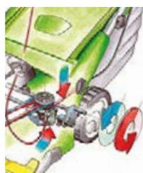
**Регулируемый привод Vario:** возможность плавного регулирования скорости привода колес посредством рычага на ручке управления. Таким образом, можно всегда выбрать идеальный темп работы.
