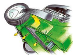
**Сменные защитные крылья:** дополнительная защита корпуса при кошении вдоль стен и кромок обеспечивает пластмассовыми защитными крыльями. В случае износа можно легко снять их и заменить на новые.
