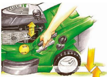
**Удобная регулировка высоты скашивания:** высота скашивания выбирается из семи уровней посредством подпружиненной рукоятки с индикатором.
