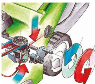
**Регулируемый привод Vario:** возможность плавного регулирования скорости привода колес посредством рычага на ручке управления. Таким образом, можно всегда выбрать идеальный темп работы.
