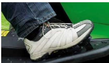
Удобство как на автомобиле с автоматической коробкой передач: **гидростатический привод** для плавной регулировки скорости.
