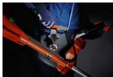
Легкое и быстрое отсоединение инструмента в экстренной ситуации.
