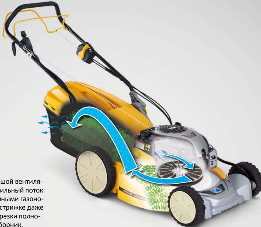
Над ножом расположен большой вентилятор, который создает более сильный поток воздуха по сравнению с обычными газонокосилками. В результате при стрижке даже влажной и высокой травы обрезки полностью перемещаются в травосборник.
