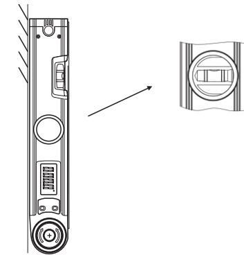
Плотно прижмите нижнюю сторону неподвижной линейки к вертикальной поверхности. Если поверхность строго вертикальна, пузыrek вертикального уровня будет расположен между отметками на колбе.
