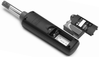
Figuur 5 – Batterijen vervangen
