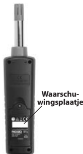
Figuur 2 – achterkant van micro HM-100 thermo-hygrometer
