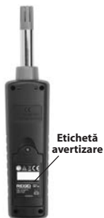
Figura 2 – Spatele aparatului de măsurare a temperaturii și umidității micro HM-100
