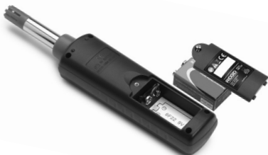
Fig. 5 – Udskiftning af batteri
