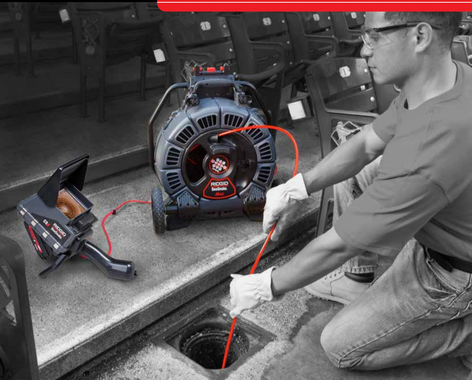
**Камера rM200 соединяет в себе портативность и универсальность серии барабанов D2, обеспечивая разные комбинации жесткости проталкивающего кабеля и гибкости спирали.**
