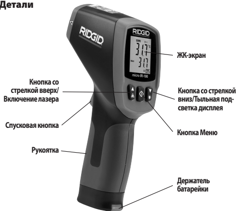
Рис. 2 – Детали прибора micro IR-100
