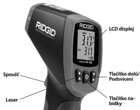
Obrázek 8 – Displej/Tlačítka micro IR-100
