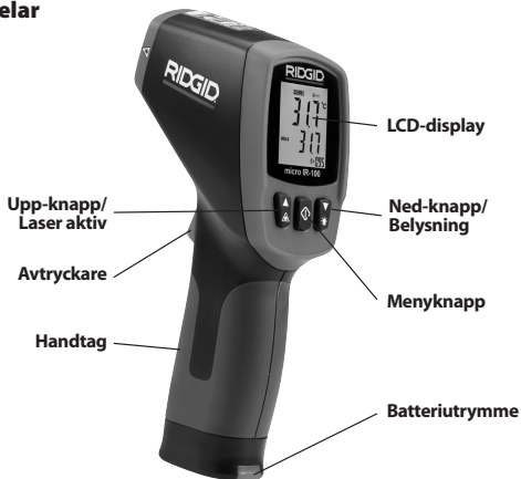
Figur 2 – Knappar på micro IR-100
