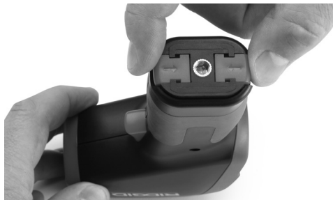
Figura 4 – Rimozione del comparto della batteria
