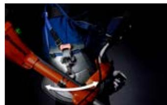
Легкое и быстрое отсоединение инструмента в экстренной ситуации. смягчающая удары «плавающая» подвеска для крепления инструмента.
