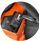
Автоматический стояночный тормоз, интегрированный в рычаги управления
