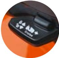
Круз-контроль позволяет трактору двигаться с постоянной скоростью даже на неровной местности
