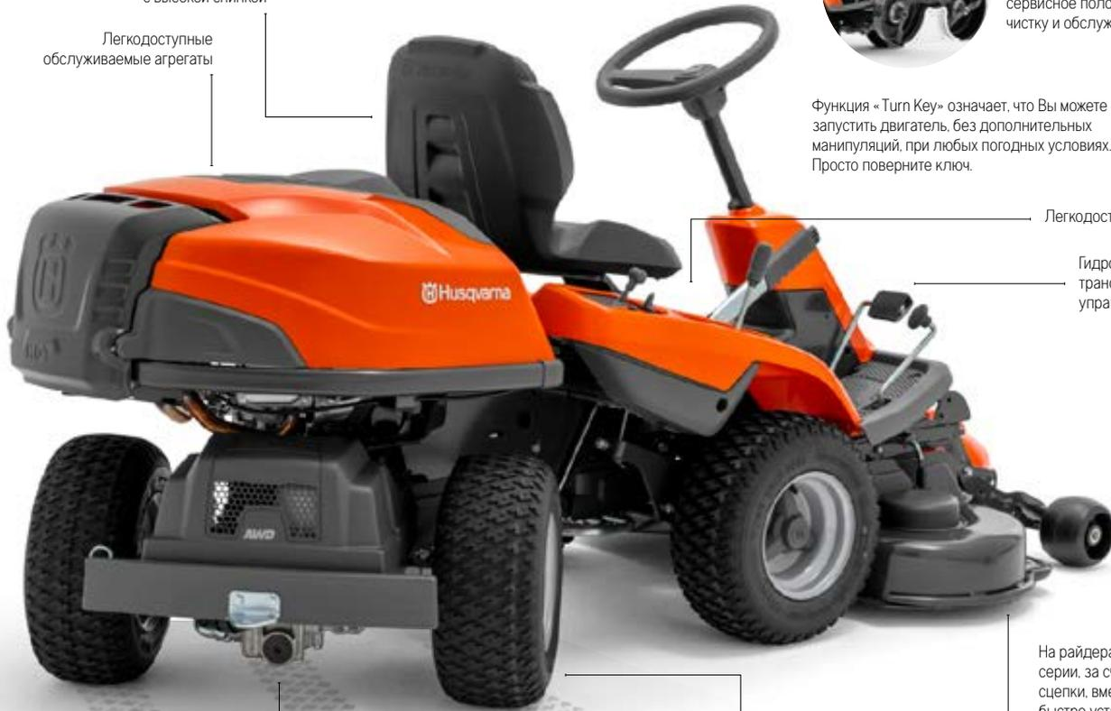
На райдерах Husqvarna 300-й и 400-й серии, за счёт уникальной конструкции сцепки, вместо режущей деки можно быстро установить роторную щётку, отвал, либо снегоотбрасыватель.
